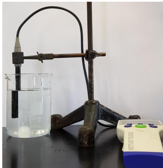
Slika 4.3 Prikaz mjerenja ionske vodljivosti prilikom ispiranja hidrogelova
