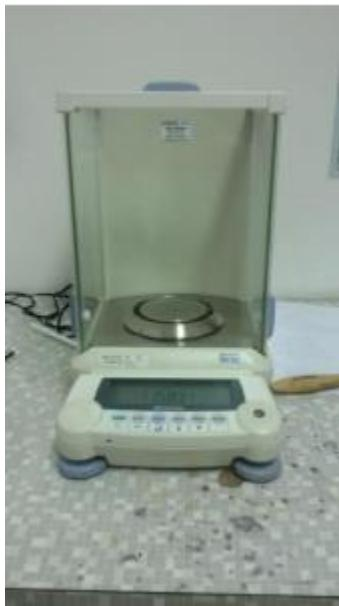
**Slika 3.1.** Analitička vaga AUW120 (Shimadzu, Japan)
