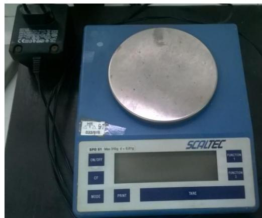
**Slika 3.2.3. Tehnička vaga Scaltec**
