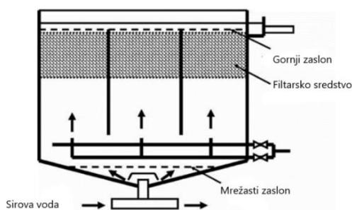
Slika 15. Sustav za obradu voda s plutajućim filtrom<sup>26</sup>
