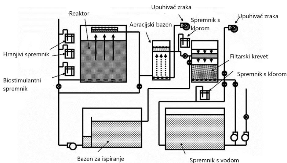
Slika 17. Proces i aparatura za biološku obradu voda<sup>26</sup>
