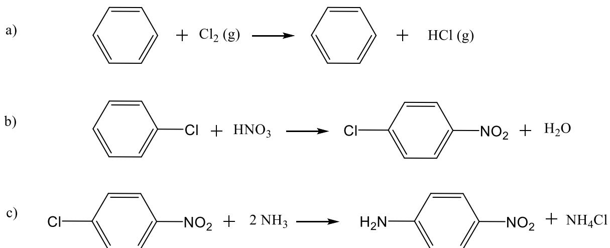
Slika 7. Priprava *p*-nitroanilina klasičnim postupkom; (a) kloriranje benzena, (b) nitriranje klorbenzena, (c) amonoliza *p*-klornitrobenzena<sup>20</sup>
