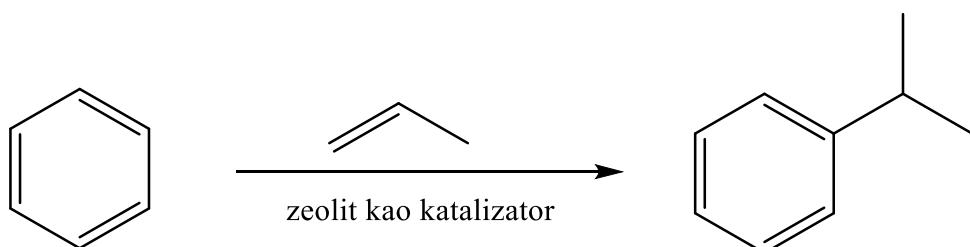
Slika 9. Mobile/Bedgerova sinteza kumena uz zeolit kao katalizator<sup>22</sup>
