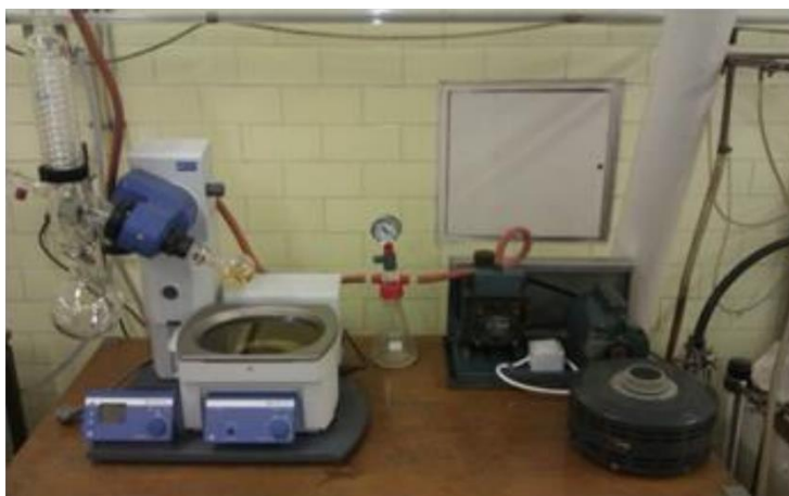
Slika 10. Rotacijski vakuumski isparivač (IKA RV 10, Basic)
