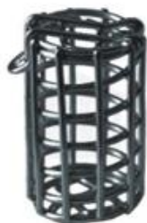
Slika 14. Košarica za potapanje tablete; fotografija i dimenzije
