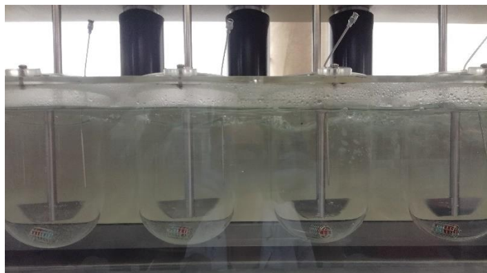
Slika 24. Postupak ispitivanja oslobađanja djelatne tvari
