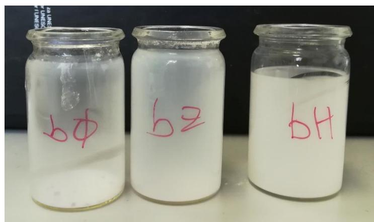
Slika 11. Prikaz staklenih bočica nakon nanošenja prevlake
