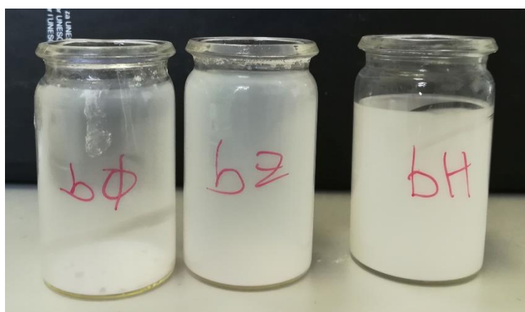
Slika 11. Prikaz staklenih bočica nakon nanošenja prevlake
