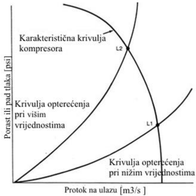
Slika 7. Karakteristična krivulja aksijalnog kompresora
