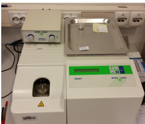
Slika 17. DSC uređaj MettlerToledo DSC 822 e
