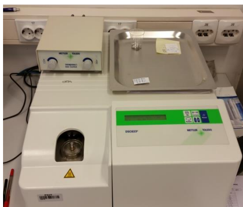
Slika 17. DSC uređaj MettlerToledo DSC 822 e
