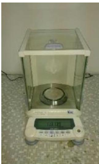
Slika 3.1 Analitička vaga *Shimadzu*
