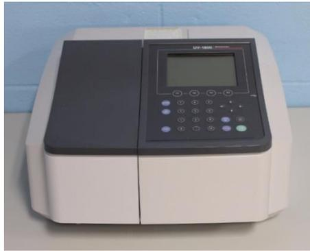
Slika 3.2 Spektrofotometar *Shimadzu UV-1800*
