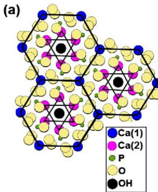
Slika 2. Kristalna struktura hidroksiapatita i položaja Ca1 i Ca2 u hidroksiapatitu [17].
