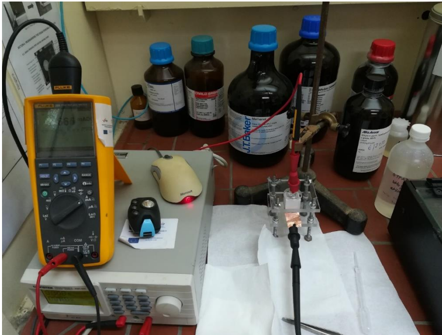
Slika 8. Fotografija eksperimentalnog postava za anodizaciju; ćelija za anodizaciju (desno), izvor DC struje i multimetar (lijevo)
