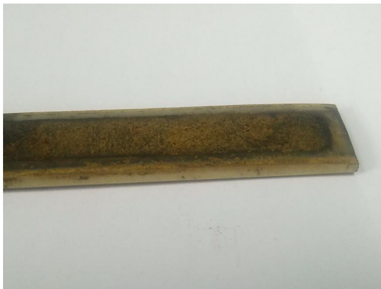
Slika 21. Dio katodno zaštićene čelične pločice koji se nalazio u vodenoj fazi.
