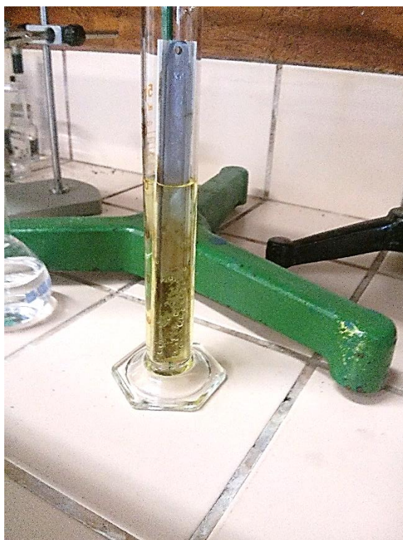
Slika 10. Reakcija otapanja korozivskih produkata očituje se pojavom mjehurića i bojanjem otopine u svjetložutu boju.
