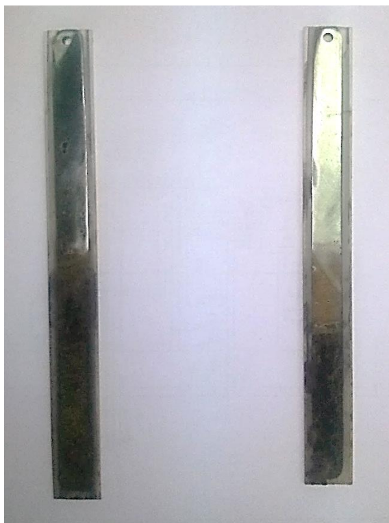
Slika 9. Uzorci čelika nakon pranja. Lijevi uzorak je bio pod katodnom zaštitom, a desni nije.
