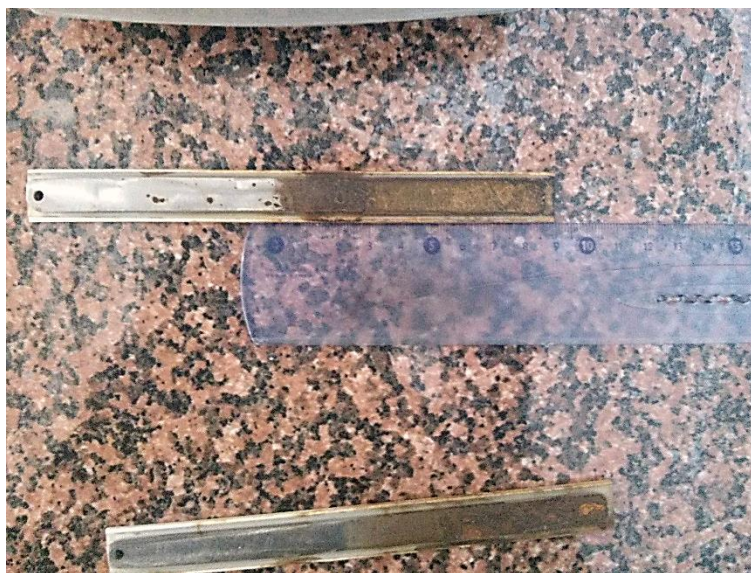
Slika 16. Mjerenje duljine dijelova pločice koji su bili uronjeni u uzorak slojne vode.
