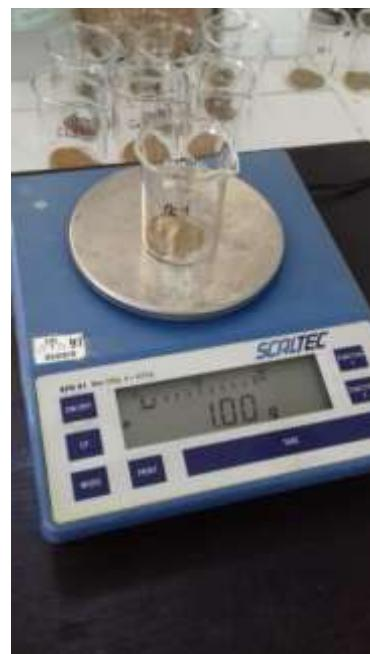
Slika 2. Tehnička vaga Scaltec
