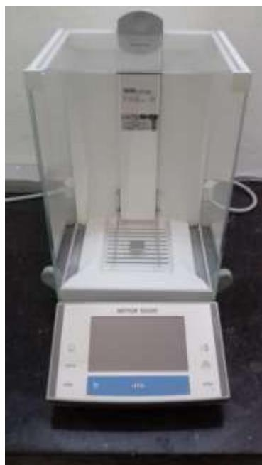
Slika 1. Analitička vaga Mettler toledo
