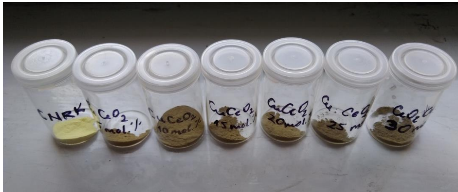
Slika 6. Uzorci čistog i bakrom dopiranog \text{CeO}_2 dobiveni hidrotermalnom sintezom. Molarni udio bakra u uzorku raste s lijeva na desno.
