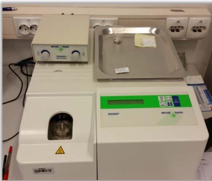
**Slika 3.5.** Fotografija diferencijalnog pretražnog kalorimetra Mettler Toledo 822<sup>e</sup>
