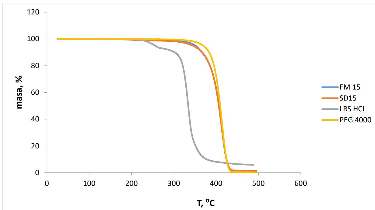
Slika 4.5. TGA krivulja za čiste komponente LRS HCl i PEG 4000 te fizikalne mješavine i čvrste disperzije gdje je  $w(\text{LRS HCl}) = 15\%$
