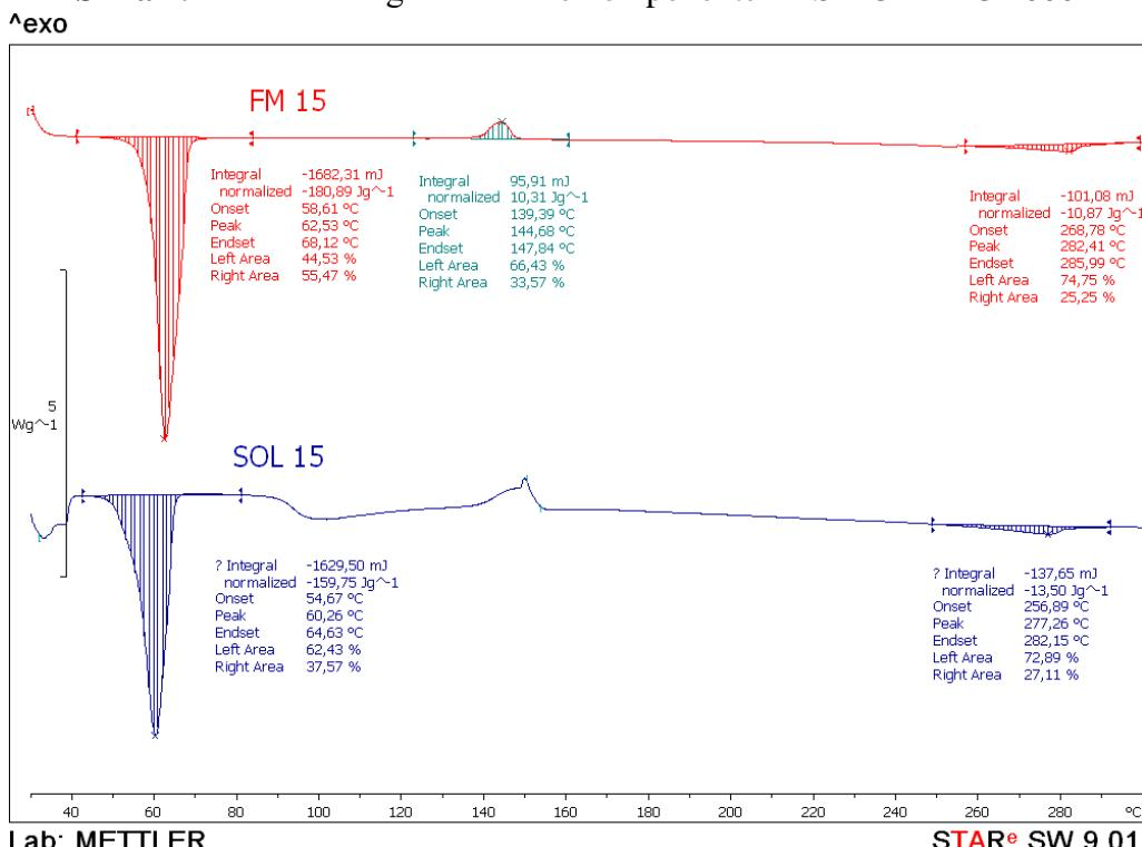
Slika 4.2. DSC termogram za fizikalnu mješavinu i čvrstu disperziju,  $w(\text{LRS HCl}) = 15\%$
