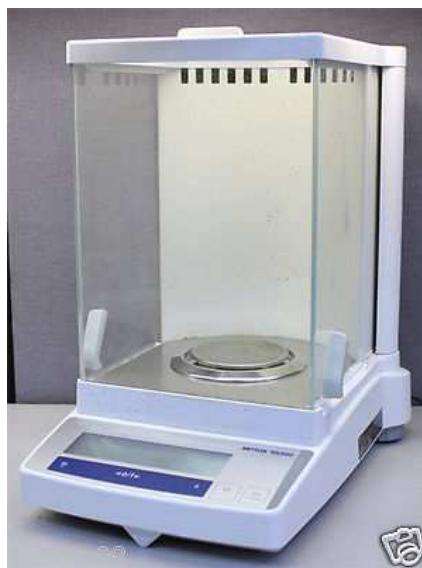
**Slika 4.** Analitička vaga Mettler Toledo, AB 104 [22]
