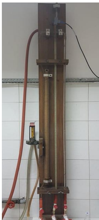
Slika 3.2. Fotografija sustava cijevi i konduktometrijske ćelije
