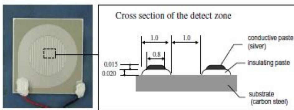
Slika 16. Prikaz Fe-Ag tipa ACM senzora<sup>14</sup>
