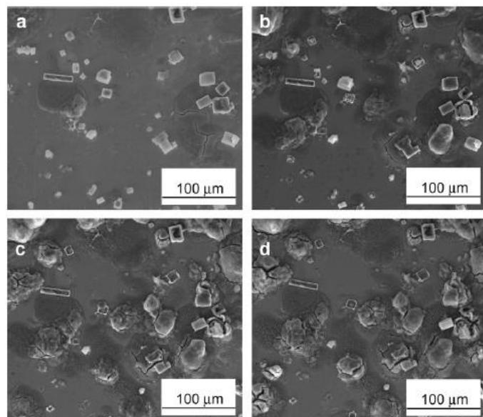
**Slika 8.** Morfologija sloja hrđe na uzorcima čelika (Cor-ten A) nakon različitih razdoblja izloženosti na 70 % RH: (a) 2 h, (b) 24 h, (c) 144 h i (d) 216 h<sup>12</sup>
