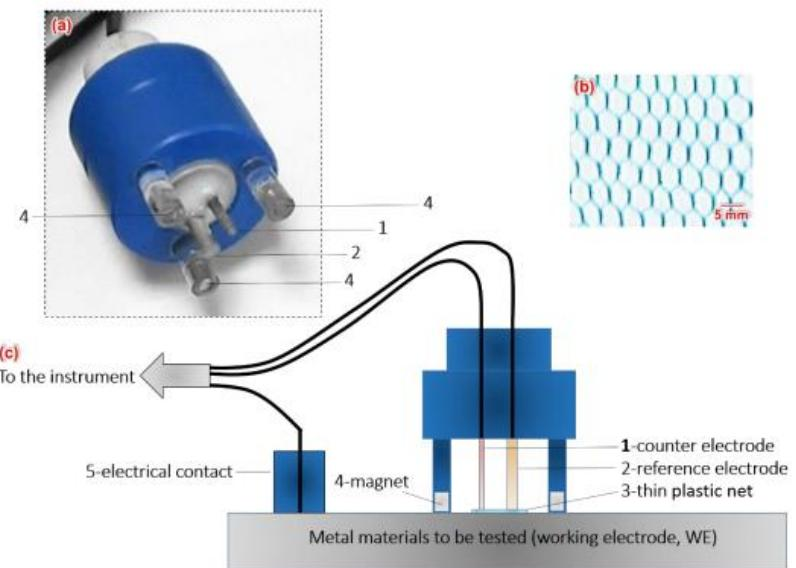
**Slika 22.** Novi elektrokemijski senzor za praćenje atmosferske korozije: a) slika senzora, b) tanka plastična mreža i c) skica senzora<sup>15</sup>
