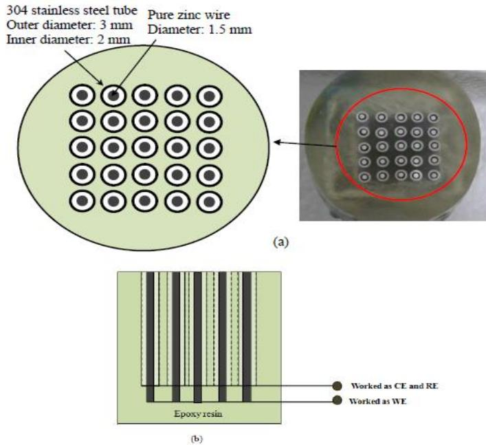
**Slika 10.** Dizajn višeekrodnog senzora: a) gornji pregled i b) bočni pregled<sup>11</sup>
