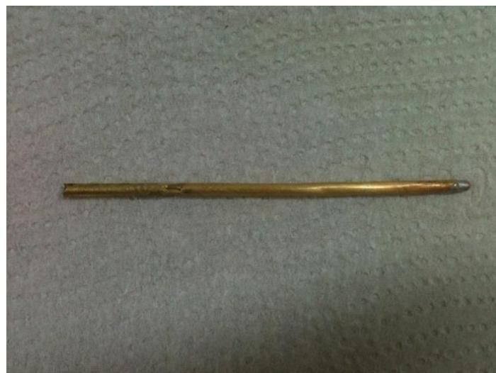
Slika 7. Bakreni nosač termopara
