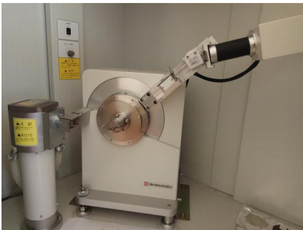
Slika 10: Korišteni uređaj za rendgensku difrakciju, XRD 6000 Shimadzu
