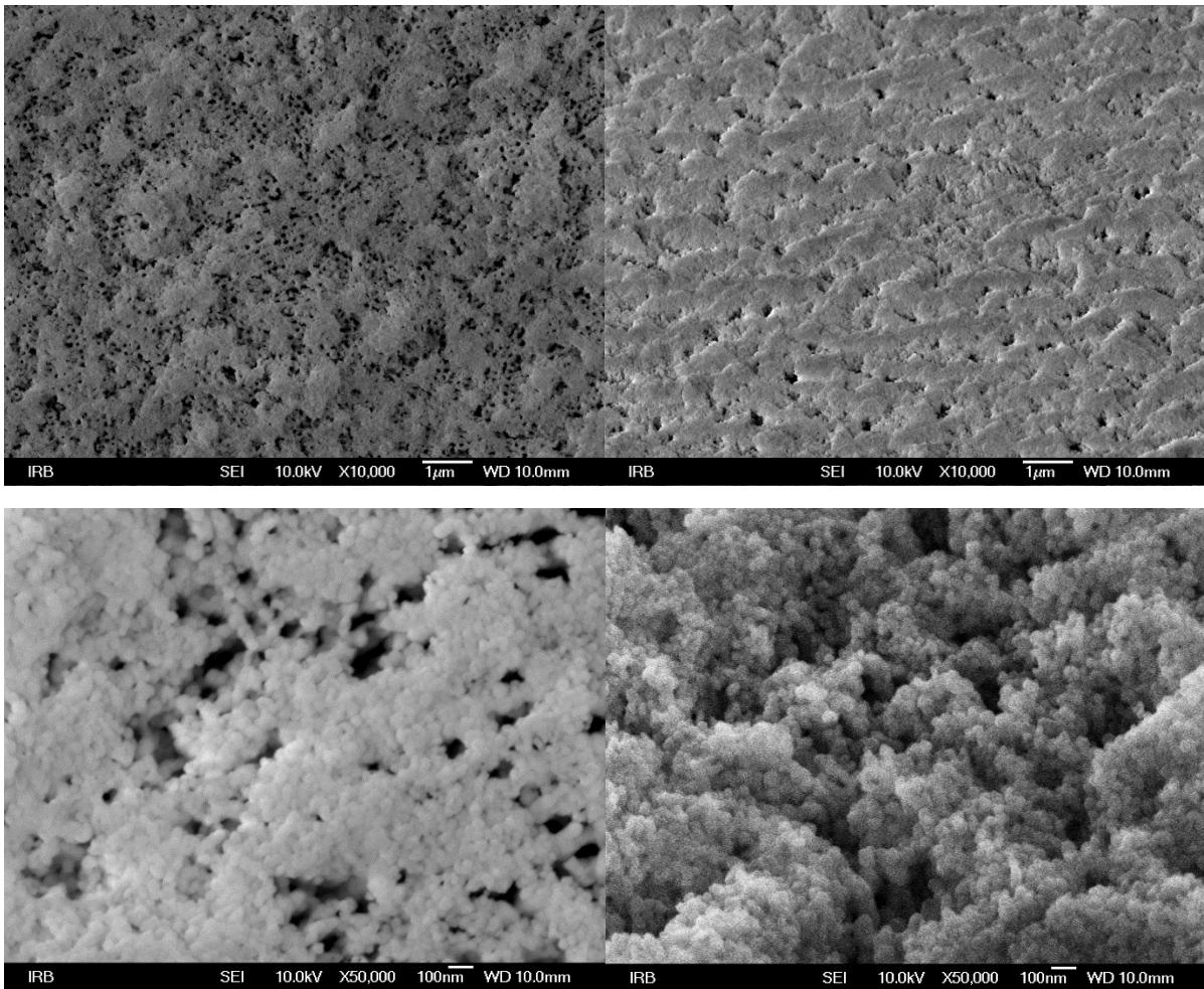
Slika 12. SEM snimke anodiziranih  $\text{TiO}_2$  nanocjevčica sa  $\text{BaTiO}_3$
