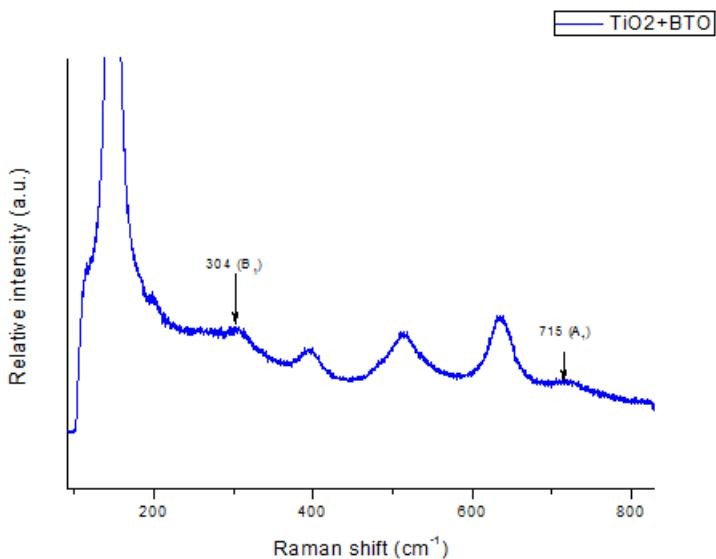
Slika 16. ramanski spektar za  $\text{TiO}_2$  nanocjevčice dekorirane sa  $\text{BaTiO}_3$
