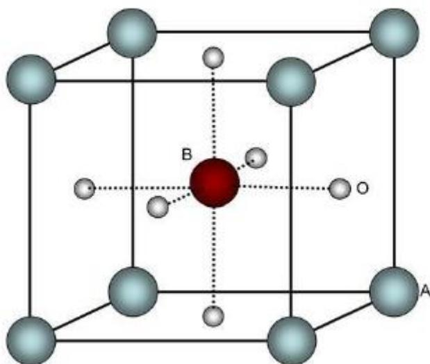
Slika 3. Jedinična čelija perovskita tipa  $\text{ABO}_3$
