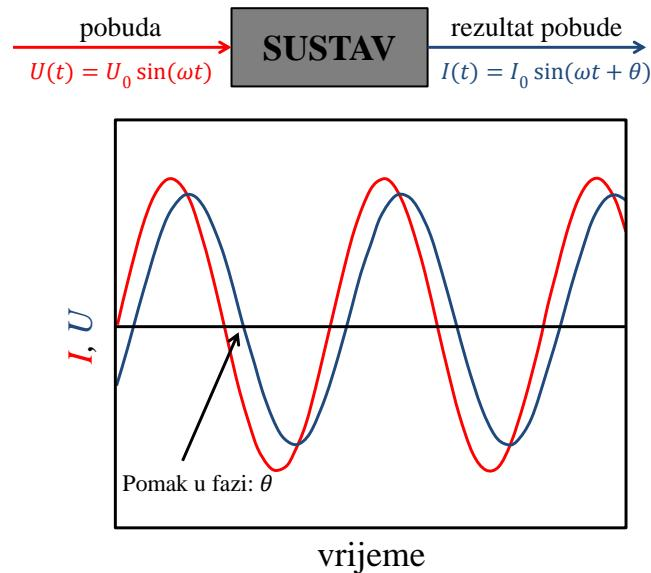
Slika 6. Prikaz primjenjenog napona,  $U(t)$  i struje,  $I(t)$ , koji se koriste za računanje kompleksne impedancije,  $Z^*$
