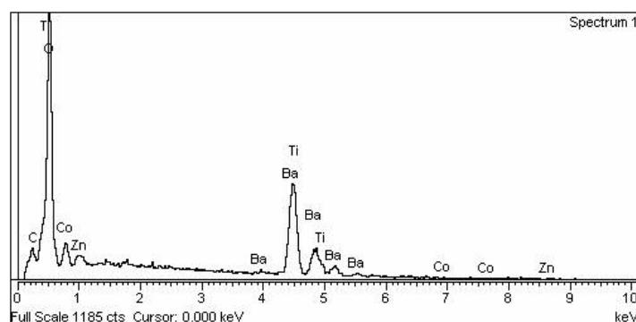
Slika 14. EDXS prikaz  $\text{TiO}_2$  nanocjevčica sa  $\text{BaTiO}_3$
