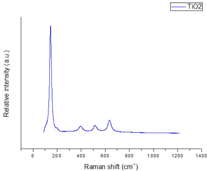
Slika 15. ramanski spektar za  $\text{TiO}_2$  nanocjevčice
