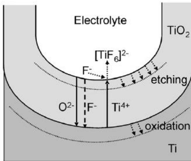
Slika 2. Shematski prikaz anodizacije Ti u prisutnosti fluorida
