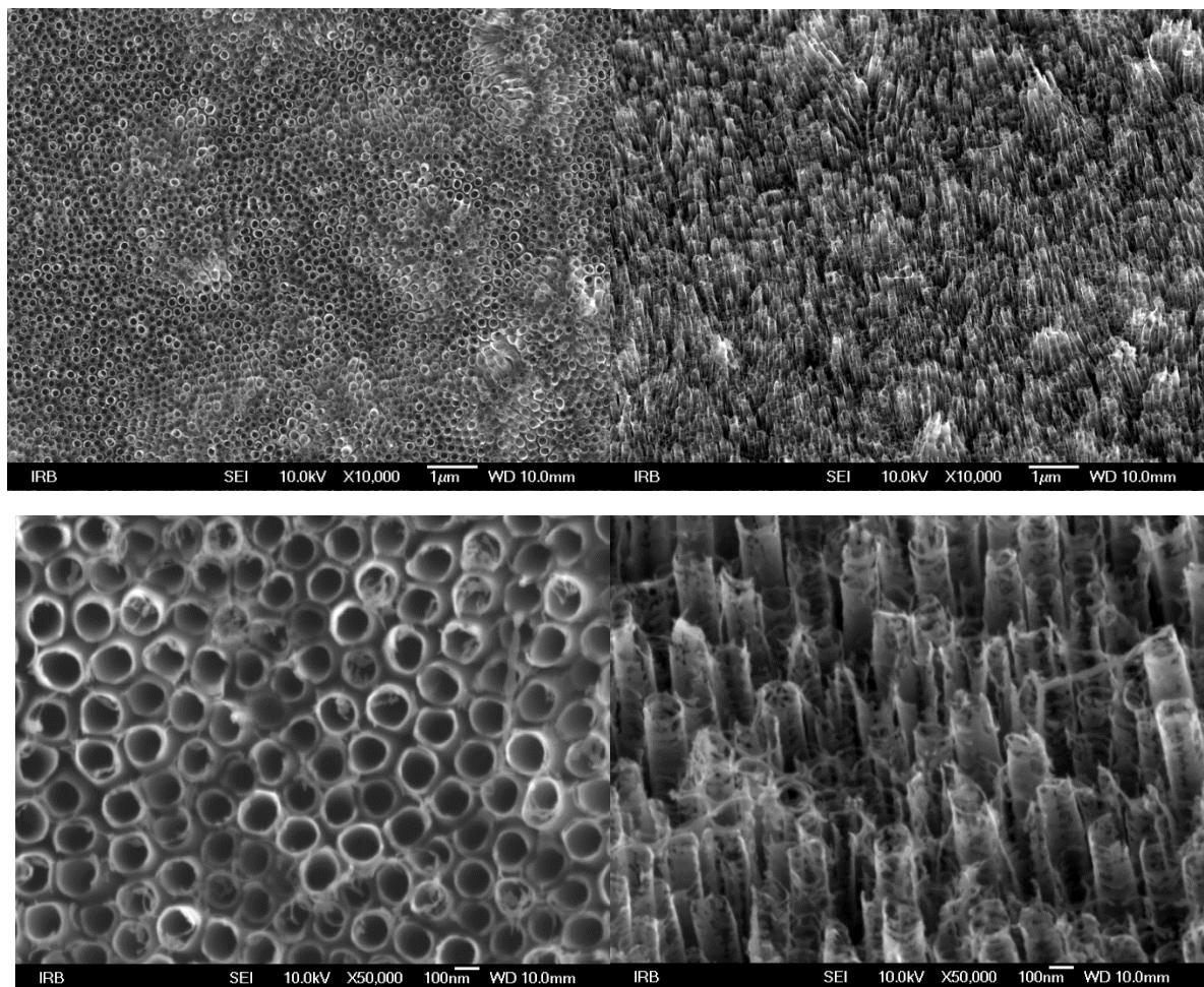
Slika 11. SEM snimke anodiziranih  $\text{TiO}_2$  nanocjevčica bez  $\text{BaTiO}_3$
