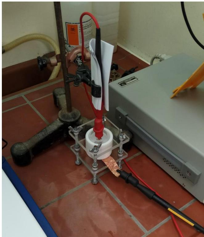
Slika 7. Prikaz aparature za anodizaciju
