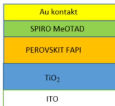
Slika 13. Shema slojeva solarne ćelije korištene u SCAPS simulaciji
