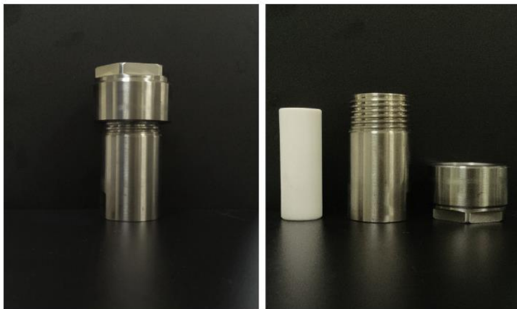
Slika 10. Moreyjev autoklav najčešće korišten za hidrotermalnu sintezu. [73]
