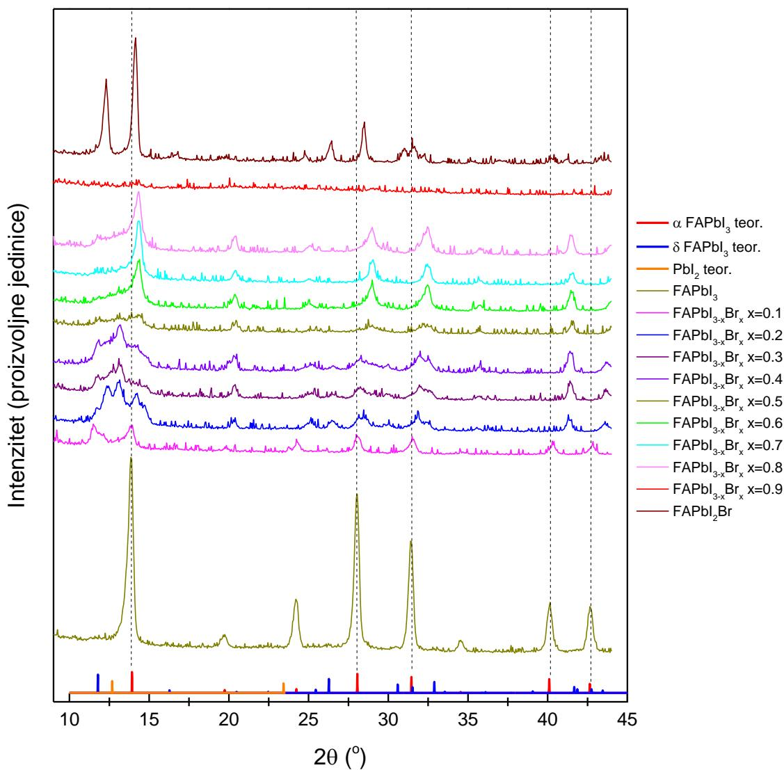
Slika 31. Eksperimentalni difraktogrami formamidinijevih olovnih perovskitnih tankih filmova različitih halidnih sastava (prvi dio)
