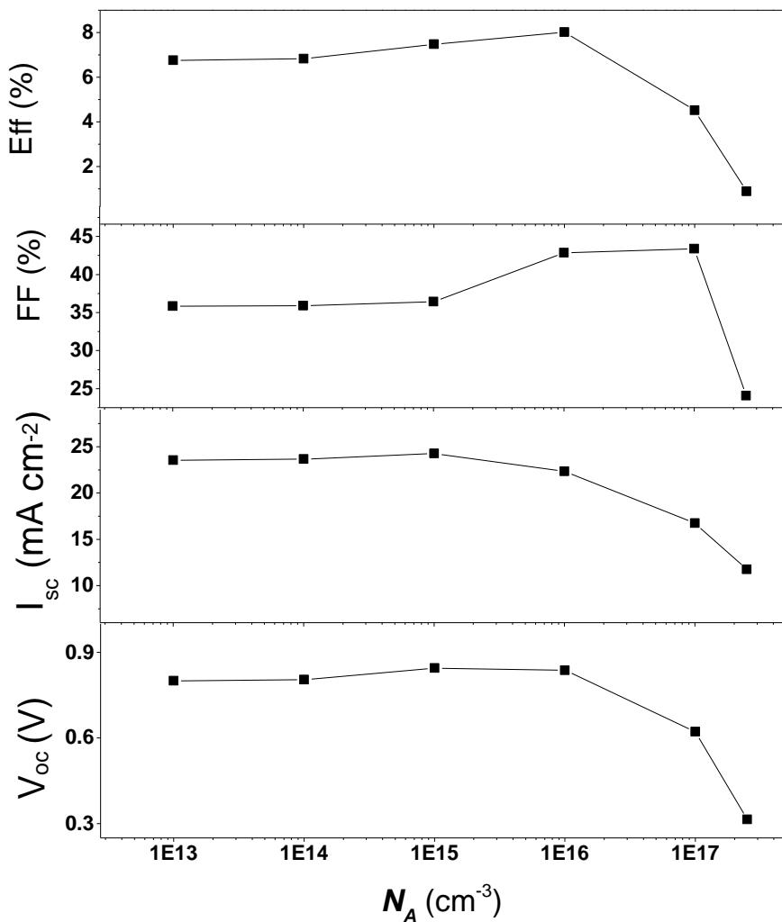
Slika 43. Promjena parametara fotonaponske ćelije sa promjenom koncentracije akceptora  $N_A$ .
