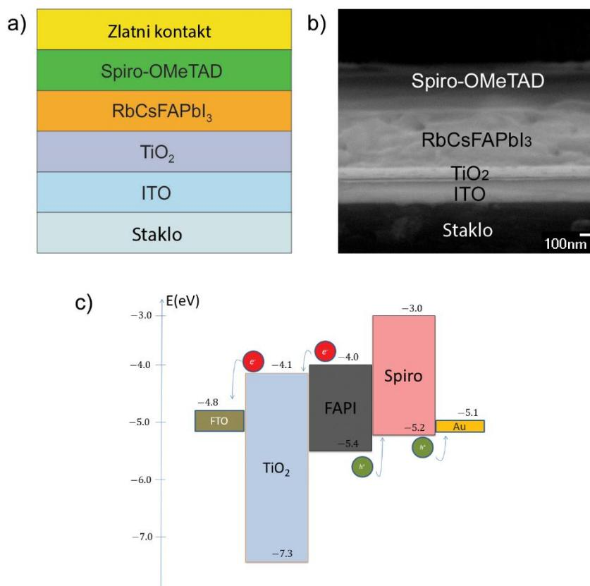
Slika 41. (a) Struktura  $\text{Rb}_{0.05}\text{Cs}_{0.10}\text{FA}_{0.85}\text{PbI}_3$  fotonaponske čelije, (b) SEM mikroografi poprečnog presjeka i (c) energijski dijagram perovskitne čelije.
