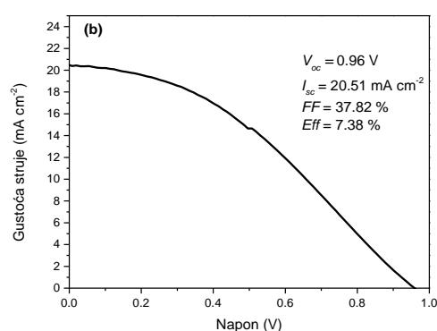
Slika 75. Prosječne  $I - V$  karakteristike  $\text{Cs}_{0.1}\text{FA}_{0.9}\text{PbI}_3$  fotonaponskih čelija (a) bez PVP-a i (b) sa PVP-om uz  $\text{TiO}_2$  kao ETL i spiro-OMeTAD kao HTL.
