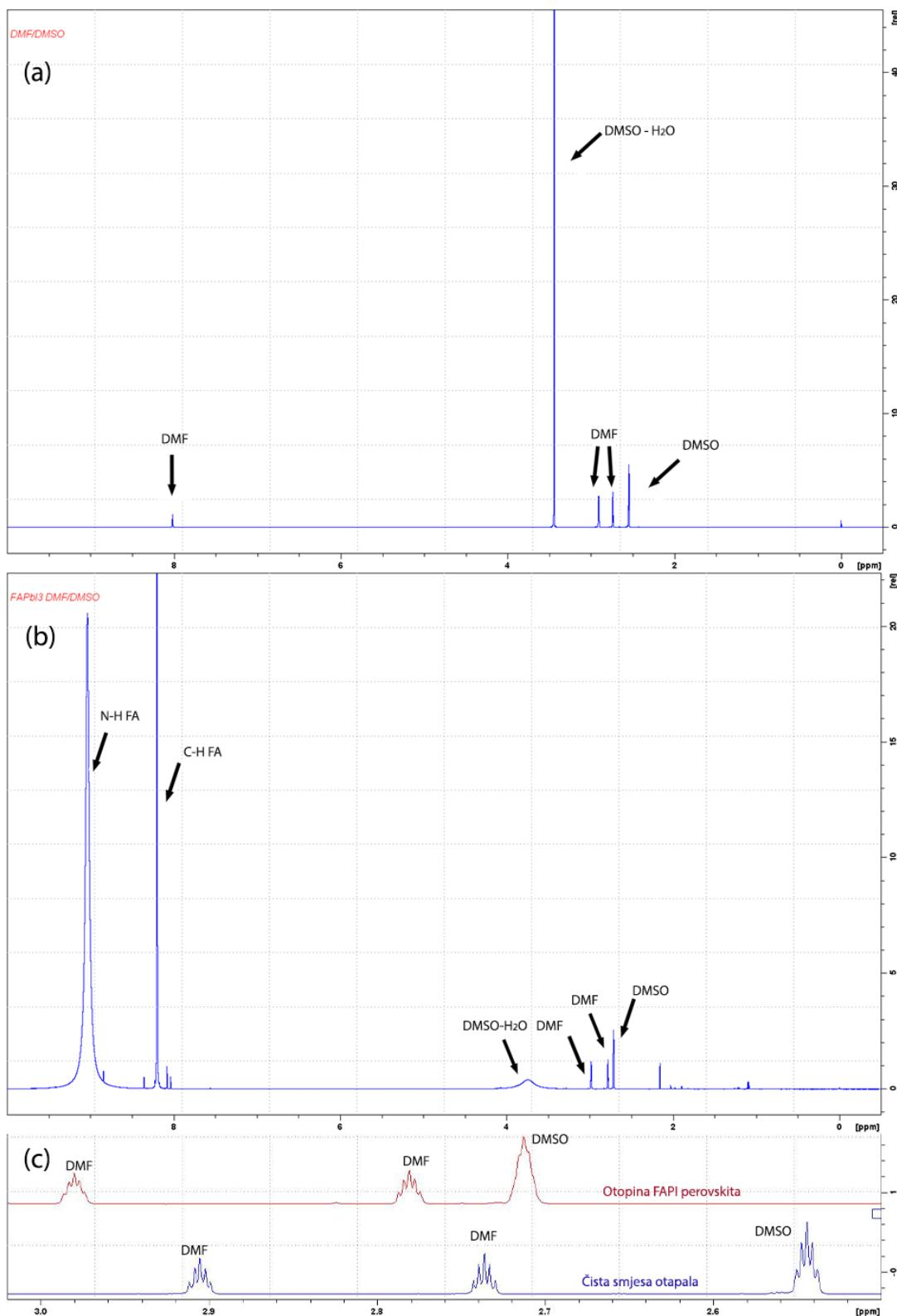
Slika 27. NMR spektri (a) čistog otapala V(DMSO):V(DMF) = 1:4 i (b) identične smjese otapala sa otopljenim FAPbI<sub>3</sub> prekursorima množinske koncentracije 1 mol L<sup>-1</sup>; (c) uvećani segment signala otapala DMF-a i DMSO-a.
