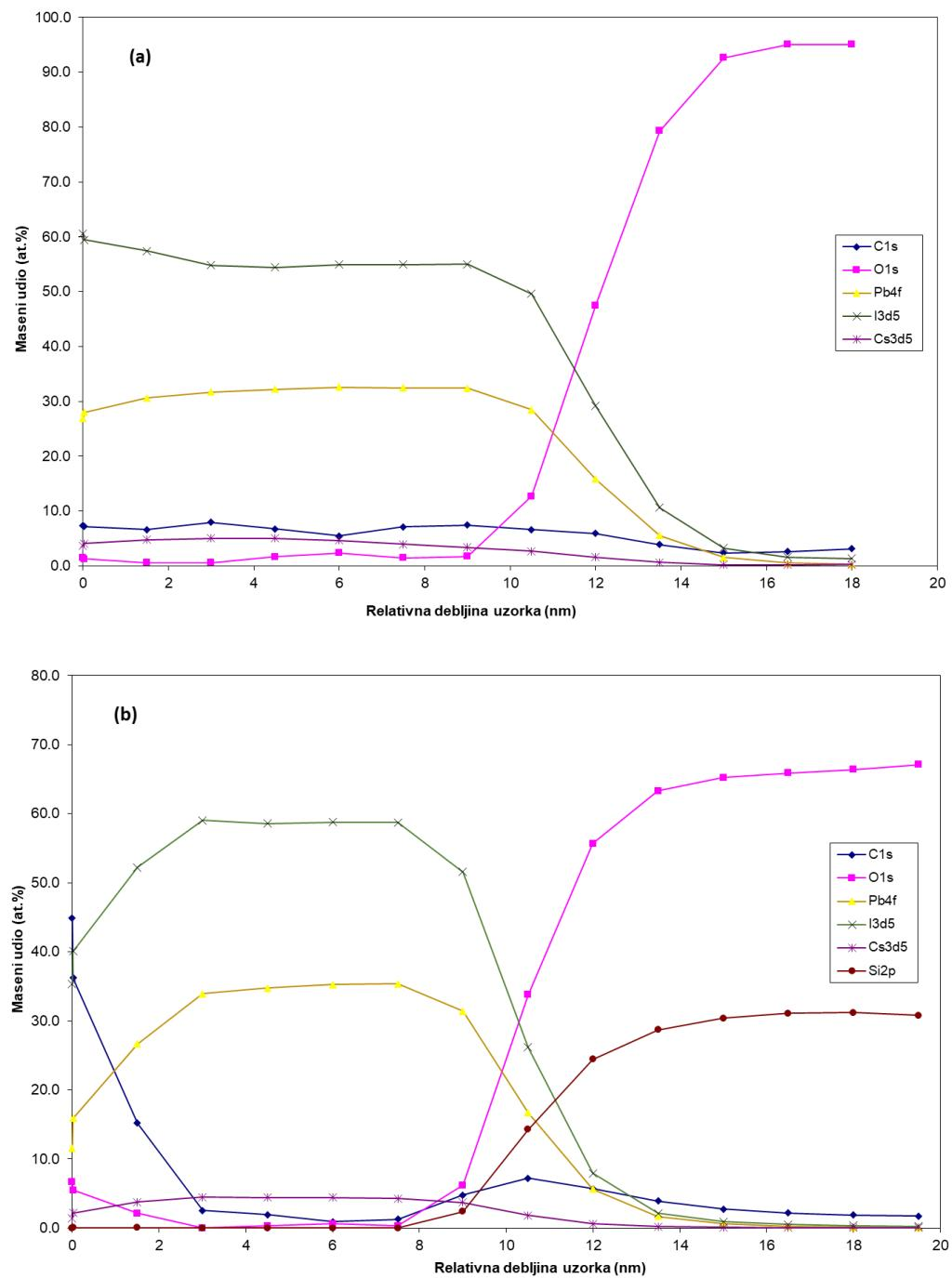
Slika 73. Dubinski profili i omjeri atomskih masa  $\text{Cs}_0\text{,}1\text{FA}_0\text{,}9\text{PbI}_3$  perovskita (a) bez PVP-a i (b) sa  $8 \text{ mg mL}^{-1}$  PVP-a.
