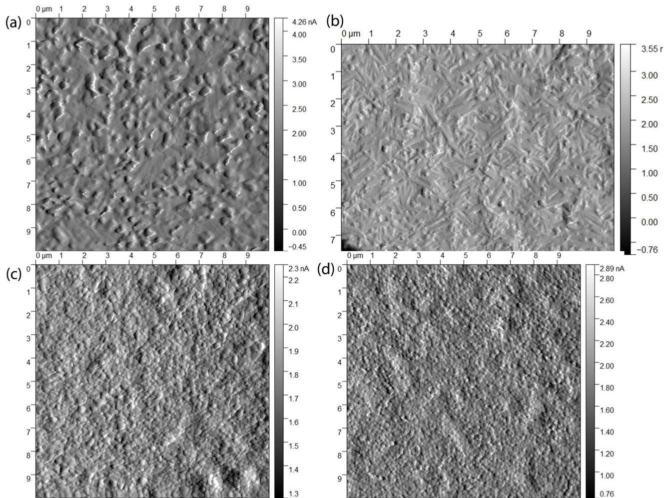
Slika 72. AFM mikrografije (a) FAPI perovskita bez PVP-a i (b) FAPI perovskita sa  $8 \text{ mg mL}^{-1}$  PVP-a aniliranog pri  $200 \text{ }^{\circ}\text{C}$  te (c)  $\text{Cs}_{0.1}\text{FA}_{0.9}\text{PbI}_3$  perovskita bez PVP-a i (d)  $\text{Cs}_{0.1}\text{FA}_{0.9}\text{PbI}_3$  perovskita sa  $8 \text{ mg mL}^{-1}$  PVP-a aniliranog pri  $150 \text{ }^{\circ}\text{C}$ .
