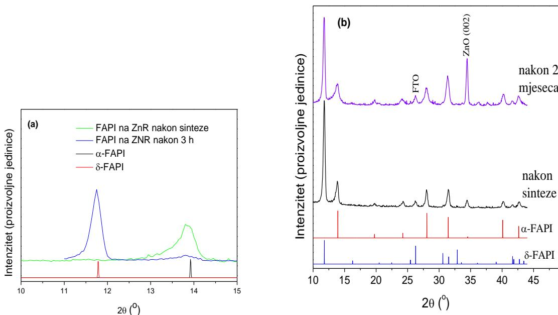
Slika 63. Difraktogrami (a) FAPI tankog filma bez PVP-a i (b) FAPI tankog filma s dodatkom PVP-a masene koncentracije  $8 \text{ mg mL}^{-1}$ .
