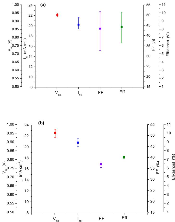
Slika 74. Raspon vrijednosti parametara funkcionalnih  $\text{Cs}_{0.1}\text{FA}_{0.9}\text{PbI}_3$  perovskitnih fotonaponskih čelija (a) bez PVP-a i (b) sa PVP-om uz  $\text{TiO}_2$  kao ETL i spiro-OMeTAD kao HTL.
