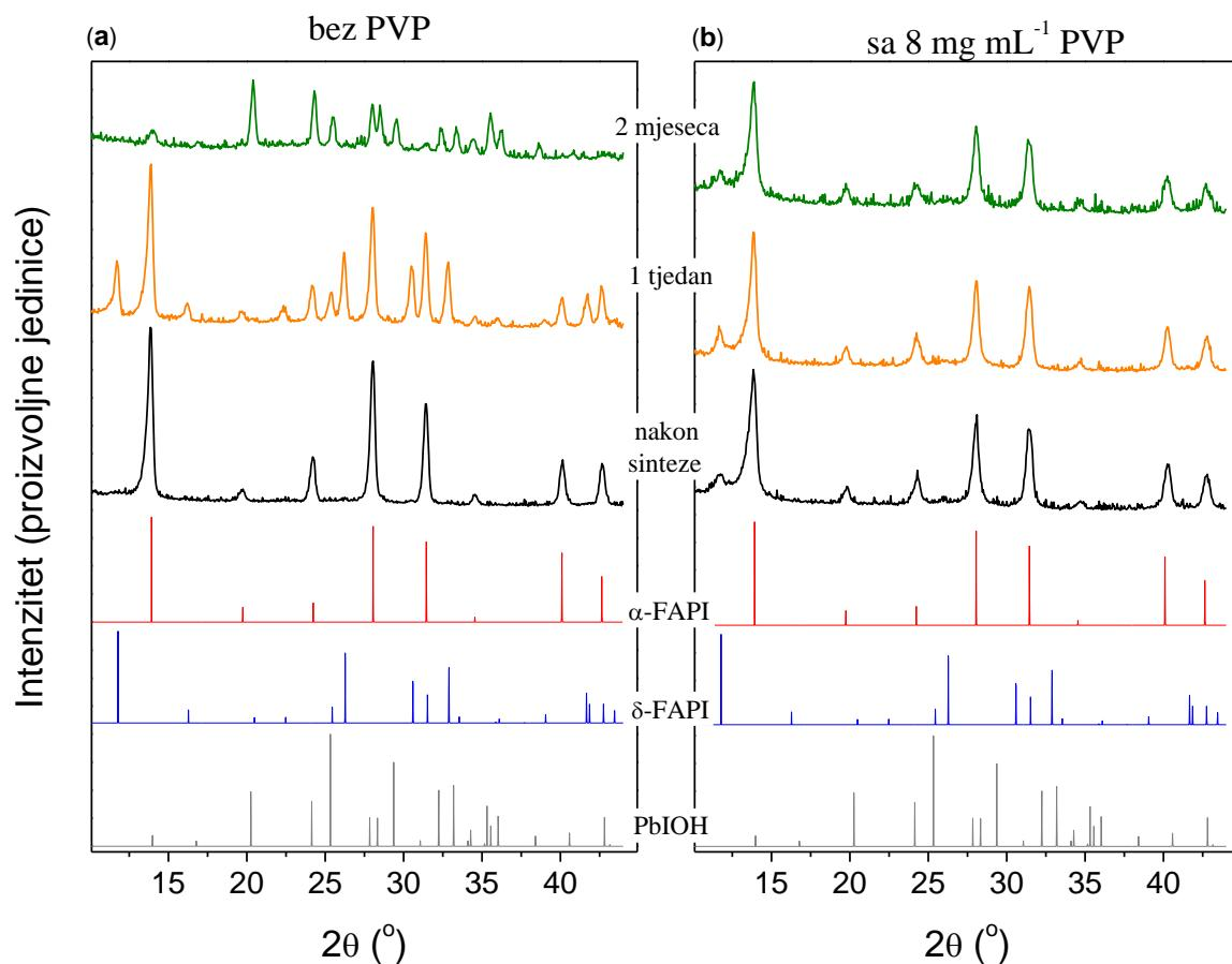
Slika 54. Difraktogrami koji pokazuju tijek degradacije (a) čistog FAPI tankog filma i (b) s dodatkom PVP-a masene koncentracije  $8 \text{ mg mL}^{-1}$ .
