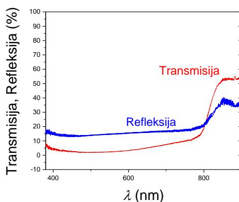
Slika 33. Primjer rezultata transmisije i refleksije za uzorak FAPbI<sub>3</sub>.
