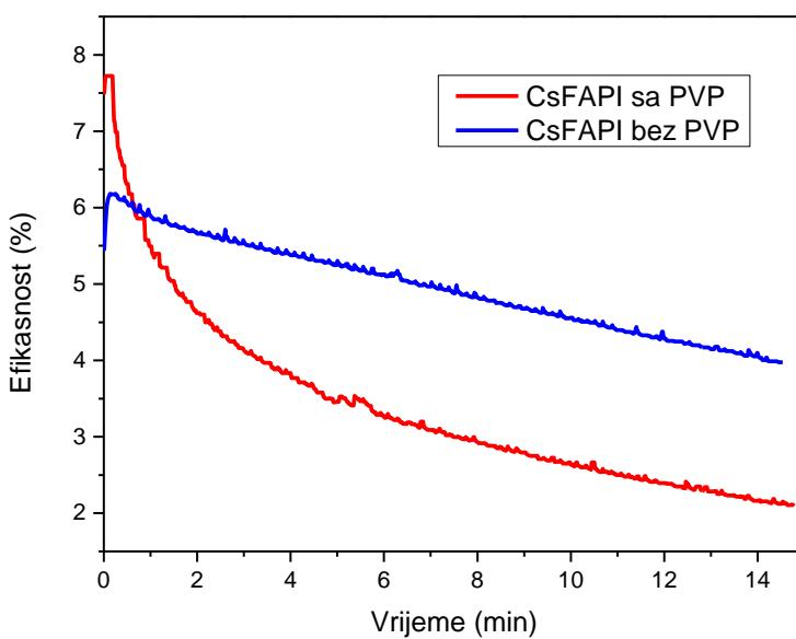
Slika 78. Praćenje iznosa efikasnosti pri maksimalnom umnošku struje i napona za  $\text{Cs}_{0,1}\text{FA}_{0,9}\text{PbI}_3$  fotonaponskih čeliju bez PVP-a i sa PVP-om uz  $\text{TiO}_2$  kao ETL i spiro-OMeTAD kao HTL.
