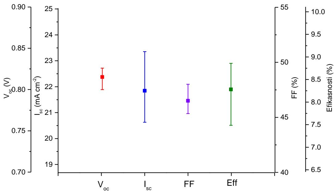
Slika 40. Raspon vrijednosti parametara funkcionalnih  $\text{Rb}_{0.05}\text{Cs}_{0.10}\text{FA}_{0.85}\text{PbI}_3$  perovskitnih fotonaponskih čelija uz  $\text{TiO}_2$  kao ETL i spiro-OMeTAD kao HTL
