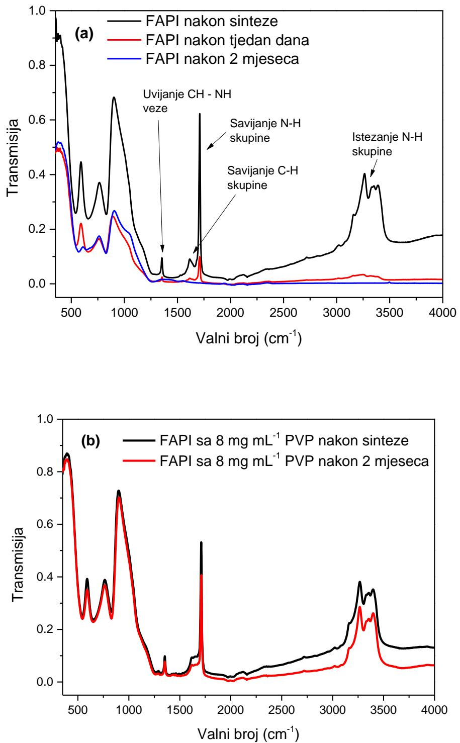
Slika 56. FTIR spektar degradacije (a) čistog FAPI tankog filma i (b) filma s dodatkom PVP-a masene koncentracije  $8 \text{ mg mL}^{-1}$ .
