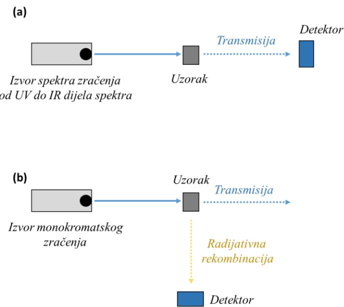
Slika 23. Eksperimentalni postav za mjerjenje (a) apsorpcije i (b) fotoluminiscencije.
