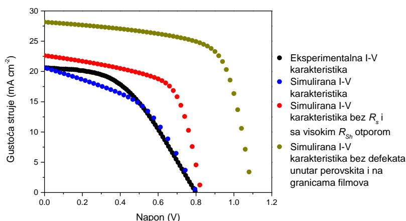
Slika 50. Rezultati računalne optimizacije  $\text{Rb}_{0,05}\text{Cs}_{0,10}\text{FA}_{0,85}\text{PbI}_3$  perovskitne fotonaponske ćelije.
