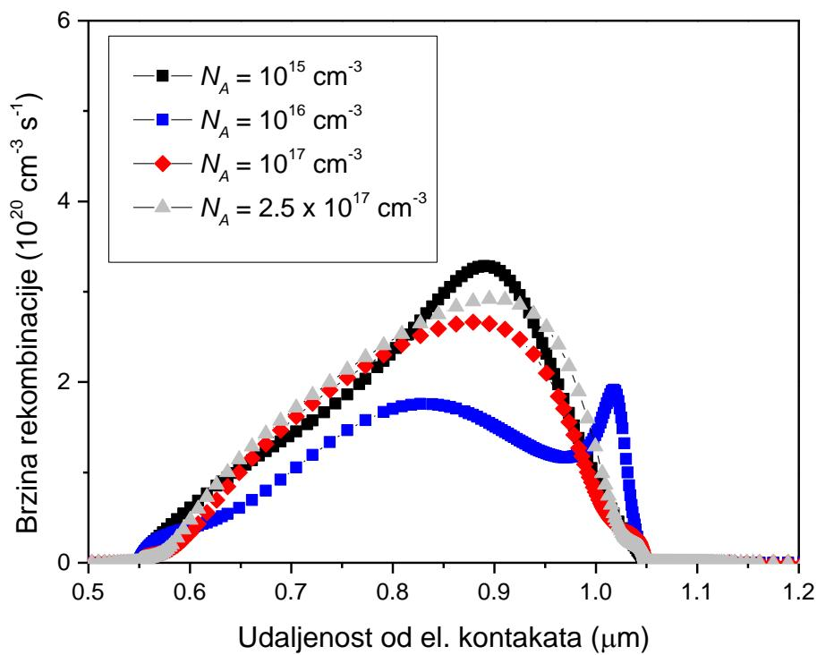
Slika 44. Brzina rekombinacije kao funkcija  $N_A$  s obzirom na udaljenost od pozadine fotonaponske čelije (el. kontakti).
