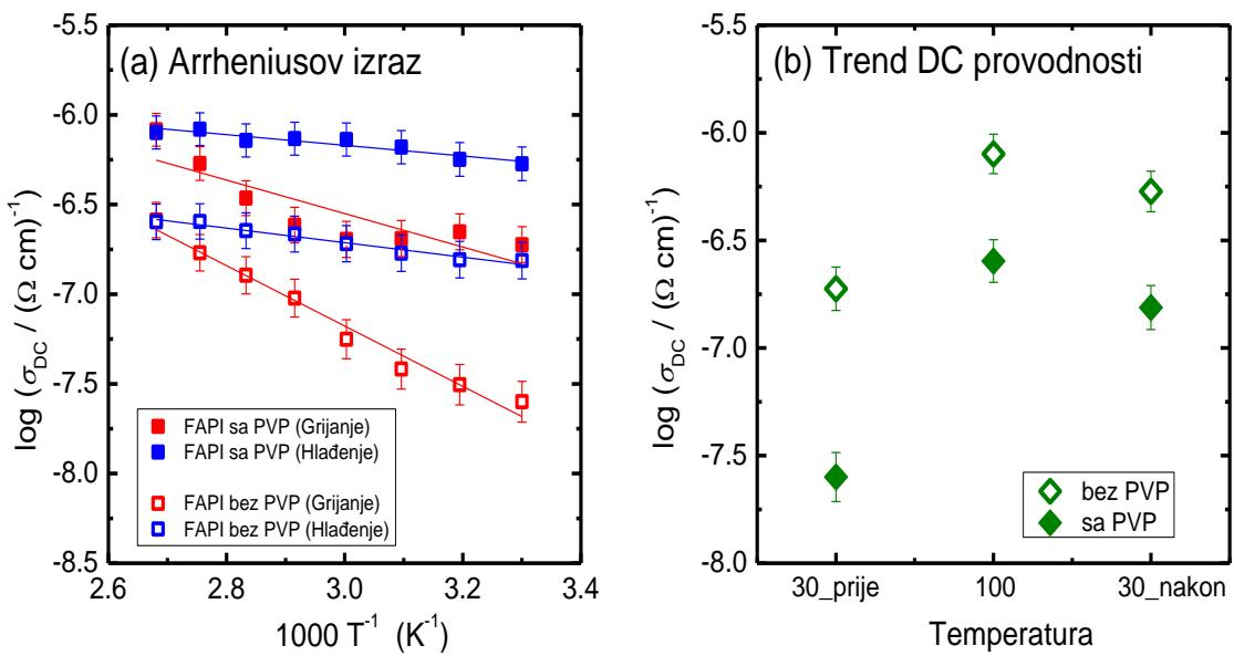
Slika 67. (a) Temperaturna ovisnost o istosmjernoj (DC) provodnosti za FAPI tanke filmove na ZnR sa i bez PVP-a i (b) DC provodnost na  $30^\circ\text{C}$  prije grijanja, pri  $100^\circ\text{C}$  te na  $30^\circ\text{C}$  nakon hlađenja.
