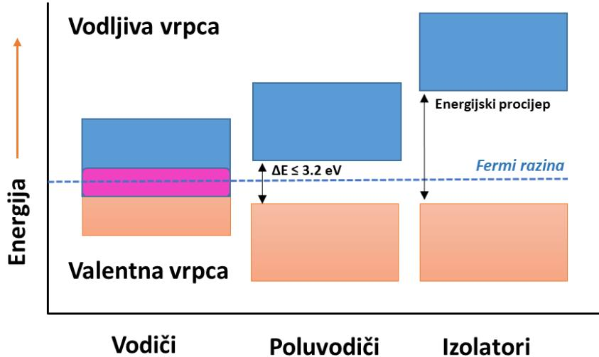
Slika 2. Energijski dijagrami vodiča, poluvodiča i izolatora.
