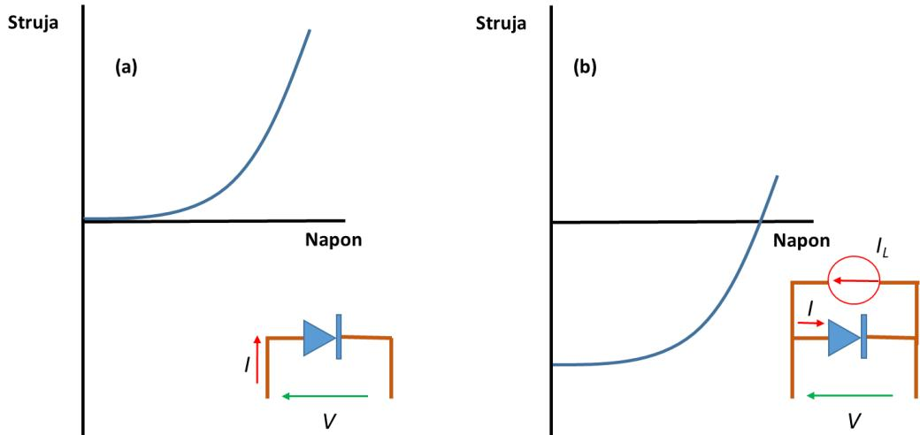
Slika 8.  $I-V$  karakteristike fotodiode u (a) mraku i (b) svijetlu sa pripadajućim strujnim krugovima.
