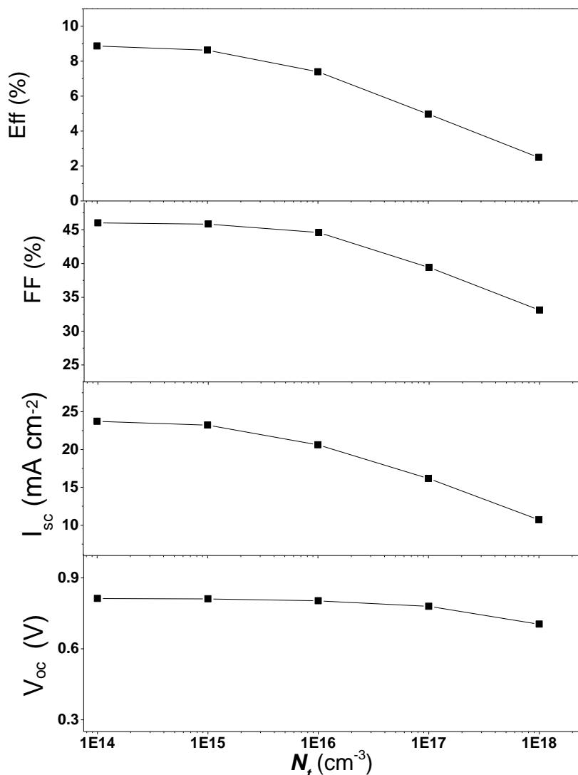
Slika 46. Promjena parametara fotonaponske čelije sa promjenom koncetracije defekata  $N_t$ .
