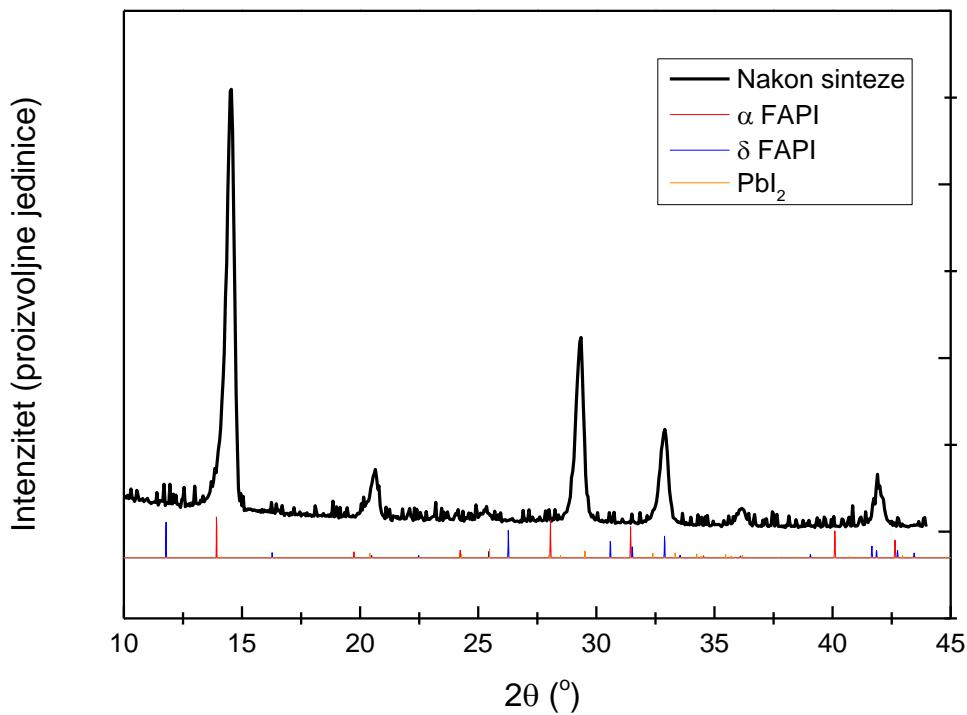
Slika 71. Difraktogram  $\text{Cs}_{0.1}\text{FA}_{0.9}\text{PbI}_3$  perovskita sa dodatkom  $8 \text{ mg mL}^{-1}$  PVP-a.
