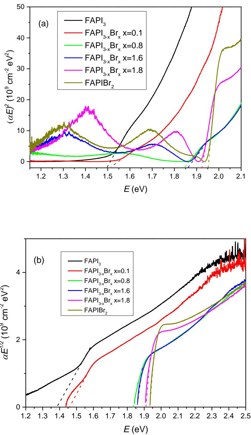
Slika 34. Taucovi dijagrami za (a) direktni i (b) indirektni energijski procijep.
