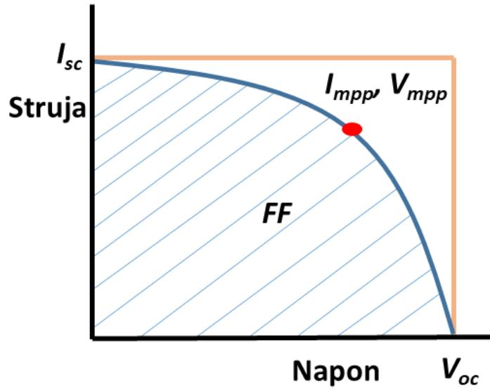
Slika 9. Strujno – naponska karakteristika i parametri fotonaponske ćelije.
