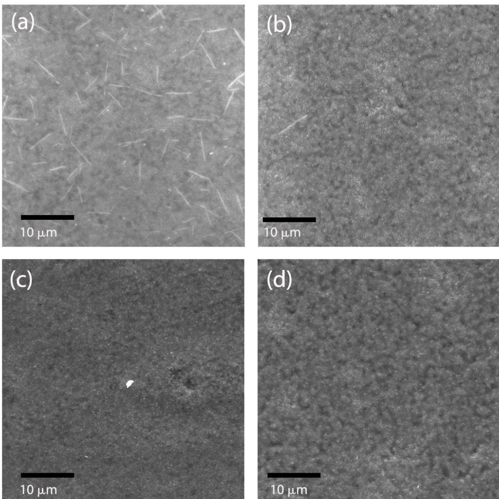
Slika 25. SEM slike FAPbI<sub>3</sub> tankih filmova sa dodatkom: (a) 50  $\mu\text{L}$ , (b) 100  $\mu\text{L}$ , (c) 150  $\mu\text{L}$  i (d) 200  $\mu\text{L}$  klorbenzena.
