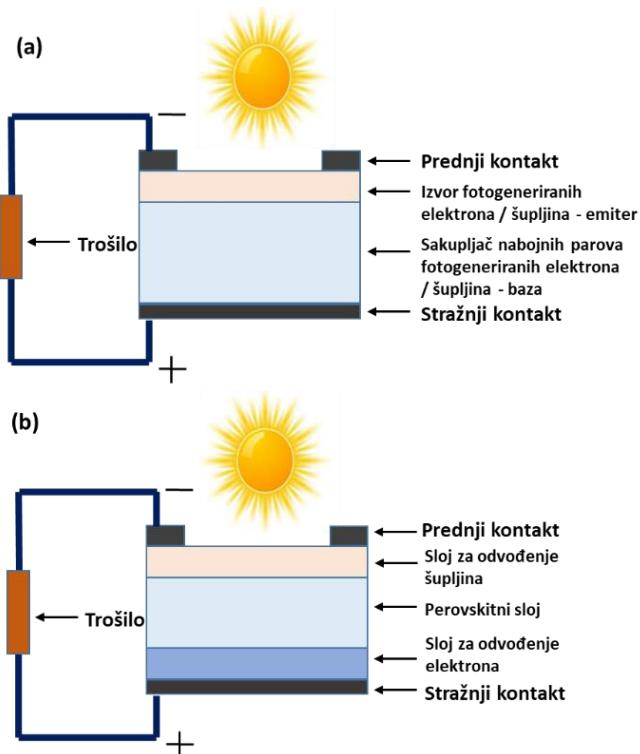
Slika 7. Osnovni elementi (a) komercijalne fotonaponske čelije na bazi silicija i (b) perovskitne čelije.
