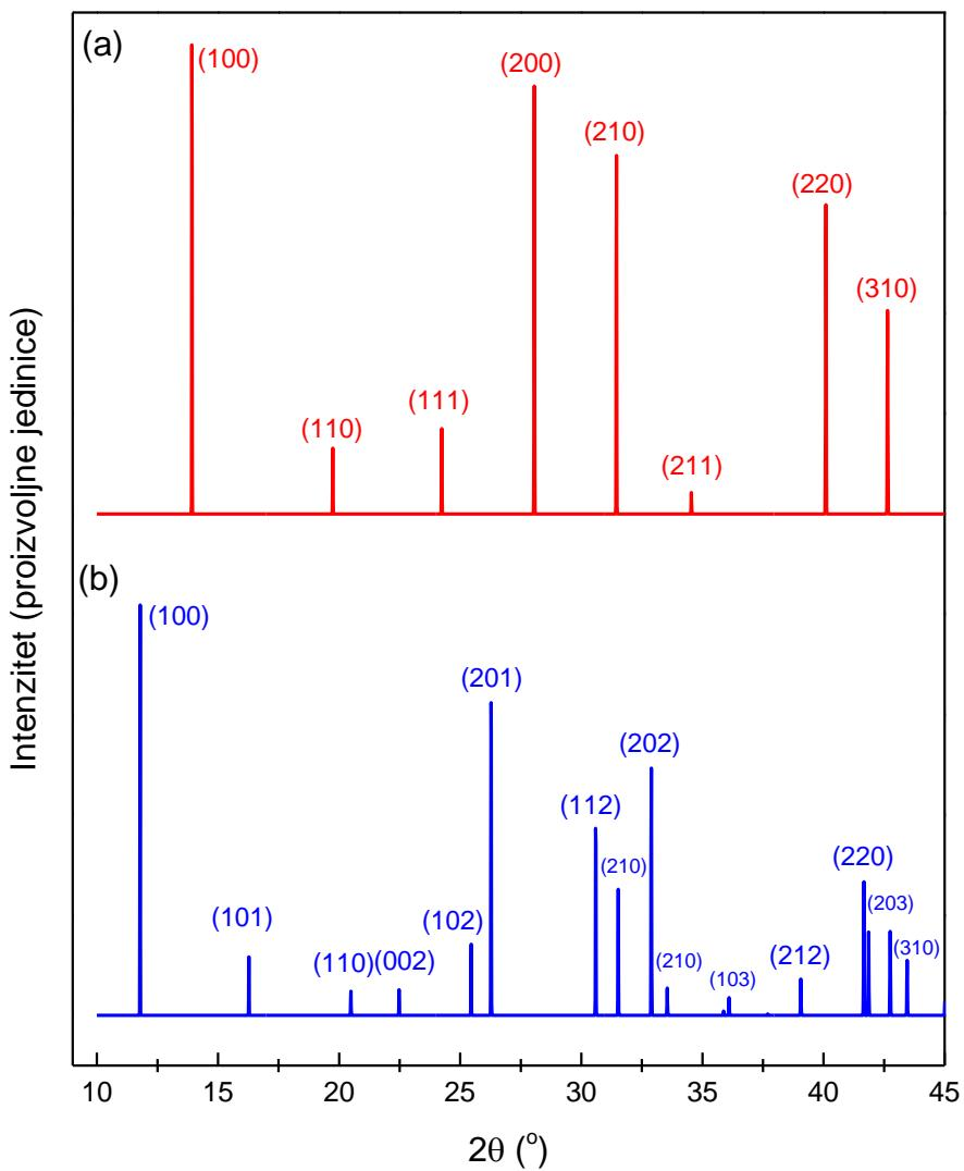
Slika 30. Teorijski difraktogrami (a)  $\alpha$  – kubične  $\text{FAPbI}_3$  strukture i (b)  $\delta$  – heksagonske  $\text{FAPbI}_3$  strukture sa pripadajućim kristalnim ravninama simetrije.
