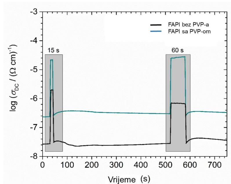
Slika 68. Mjerenje fotovodljivosti FAPI tankih filmova na ZnR sa i bez PVP-a pri frekvenciji od  $1 \text{ Hz}$  nakon  $15$  i  $60 \text{ s}$  izlaganja zračenju od  $100 \text{ mW cm}^{-2}$ .
