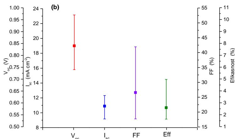
Slika 76. Raspon vrijednosti parametara funkcionalnih  $\text{Cs}_{0.1}\text{FA}_{0.9}\text{PbI}_3$  perovskitnih fotonaponskih čelija (a) bez PVP-a i (b) sa PVP-om uz  $\text{ZnO}$  kao ETL i spiro-OMeTAD kao HTL.
