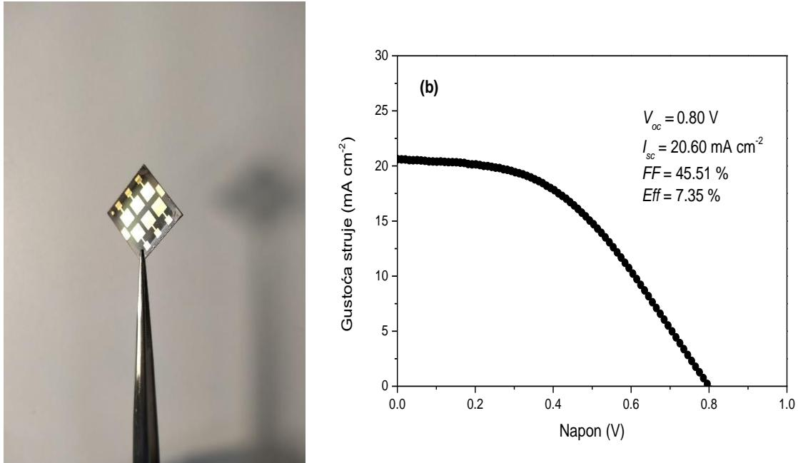
Slika 39. (a) Slika čelije i (b) strujno – naponska karakteristika  $\text{Rb}_{0.05}\text{Cs}_{0.10}\text{FA}_{0.85}\text{PbI}_3$  perovskitne fotonaponske čelije uz  $\text{TiO}_2$  kao ETL i spiro-OMeTAD kao HTL.
