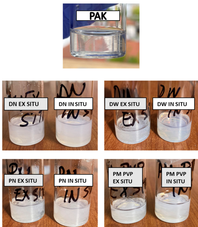
Slika 67. Prikaz neotopljenih premaza u THF-u.
