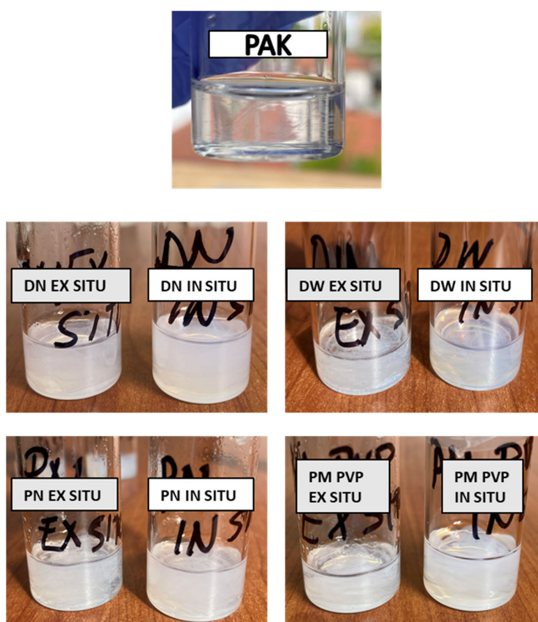
Slika 67. Prikaz neotopljenih premaza u THF-u.
