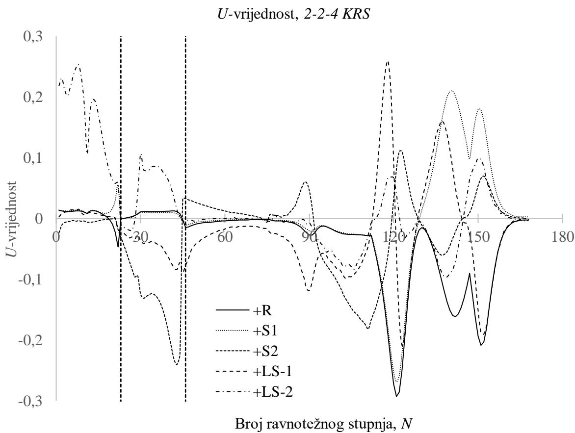
Slika 34: Grafički prikaz  $U$ -vrijednosti dobivenih SVD analizom za promjenu vrijednosti: pretoka, gornjeg bočnog proizvoda, donjeg bočnog proizvoda, gornje raspodjele kapljevine te donje raspodjele kapljevine. Vertikalne linije označavaju granicu između paralelnih sekcija – predfrakcionatora, srednjeg frakcionatora i glavnog frakcionatora.
