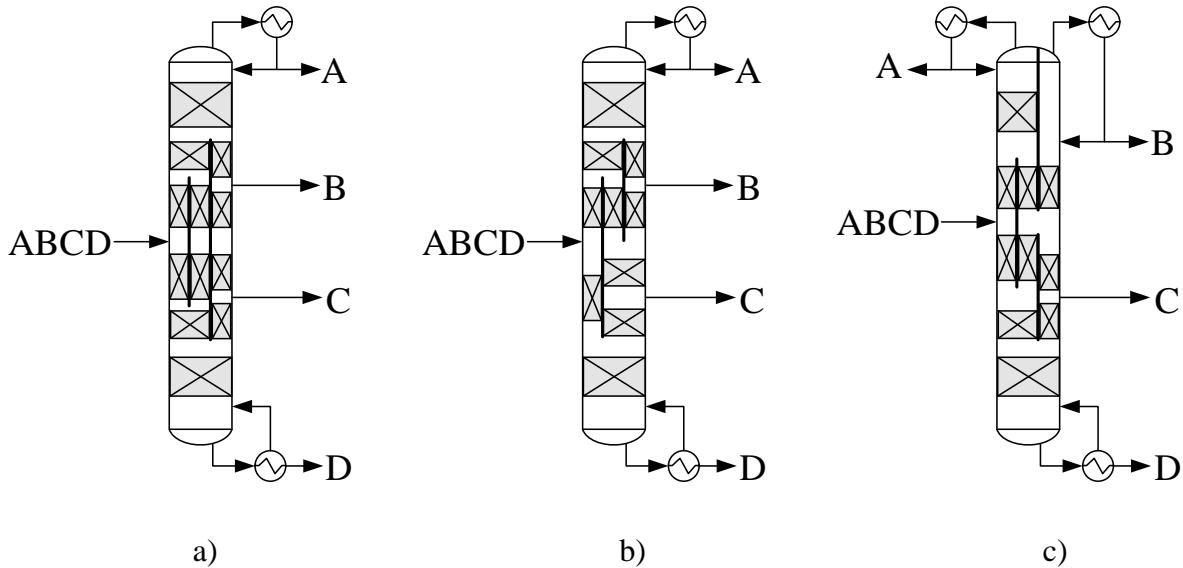
Slika 10: Konfiguracije KRS-a temeljene na modifikaciji Petlyukovog niza; a) S 2-3-4, b) 2-2-4, c) 2-3-3 konfiguracija [27]
