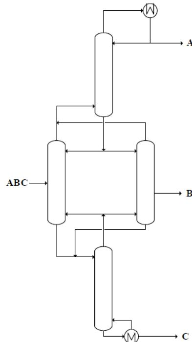
Slika 14: Model KRS-a za tri proizvoda sastavljen od četiri konvencionalne destilacijske kolone
