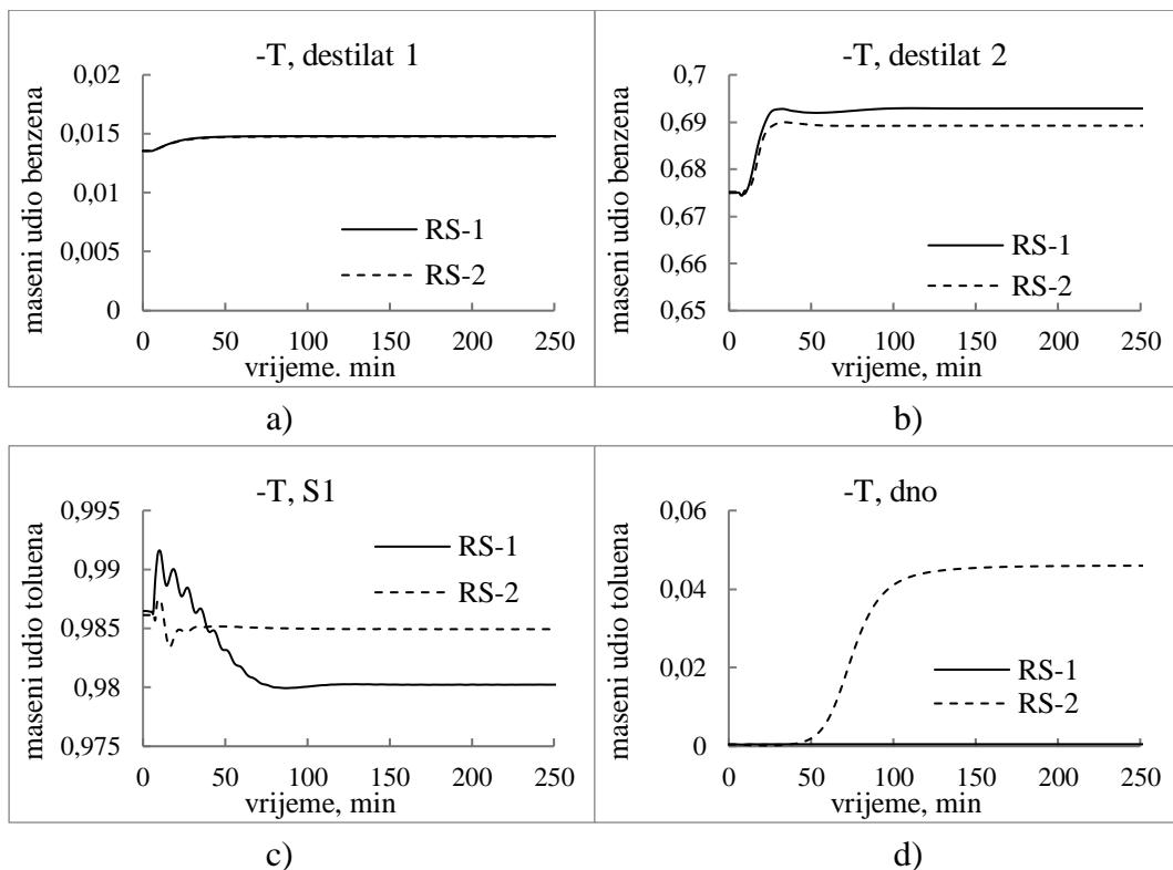
Slika 53: Odziv sastava ključnih komponenti proizvoda na promjenu sastava toluena (-10%) u ulaznoj struji: a) lijevi destilat, b) desni destilat, c) S1, d) proizvod dna.
