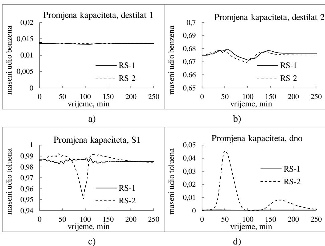
Slika 59: Odzivi sastava ključnih komponenti proizvoda na postupne promjene protoka pojne
