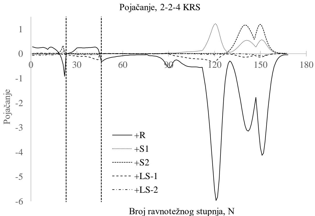
Slika 31: Grafički prikaz statičkog pojačanja ovisno o promjeni vrijednosti pojedinog stupnja slobode 2-2-4 konfiguracije KRS
