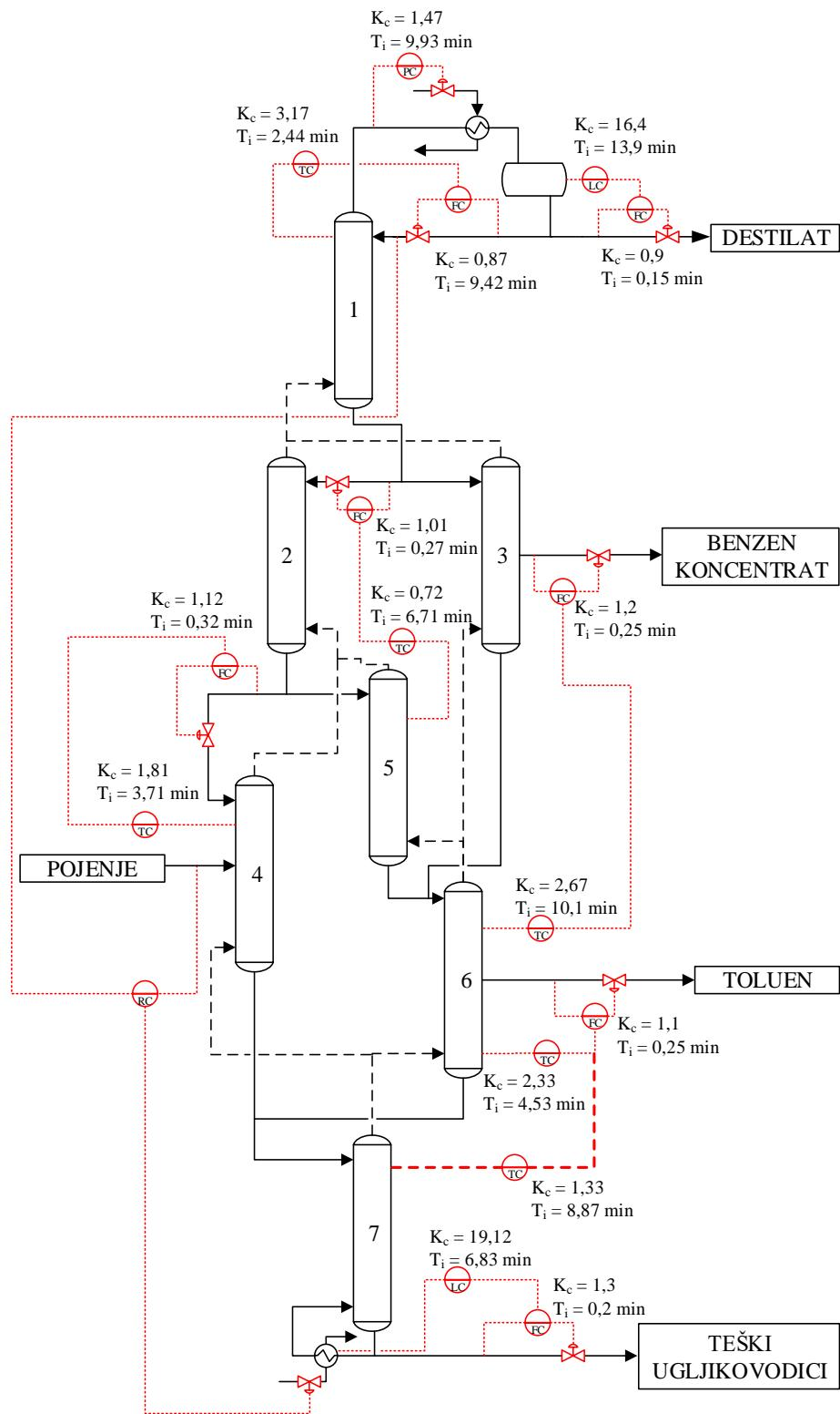
Slika 36: Pojednostavljena shema proširenog modela 2-2-4 konfiguracije KRS-a s označenim približnim lokacijama vođenih varijabli dobivenim analizom osjetljivosti i SVD analizom. Debelo otisnutom crtkom linijom prikazana je razlika između dvije regulacijske sheme – shema dobivena SVD-om regulira temperaturu pri vrhu kolone br. 7
