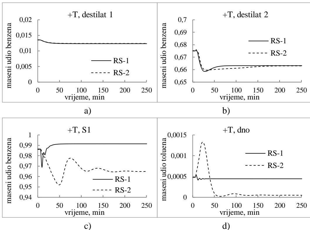
Slika 52: Odziv sastava ključnih komponenti proizvoda na promjenu sastava toluena (+10%) u ulaznoj struji: a) lijevi destilat, b) desni destilat , c) bočni proizvod (S1), d) proizvod dna.
