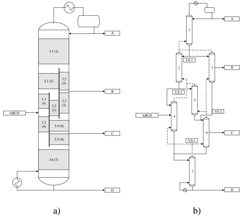
Slika 30: Raspored sekcija u 2-2-4 konfiguraciji KRS (a) i shema simulacijskog modela sa sedam kolona (b). Brojevi u zagradama označavaju broj kolone u kojoj se simulira ta sekcija.
