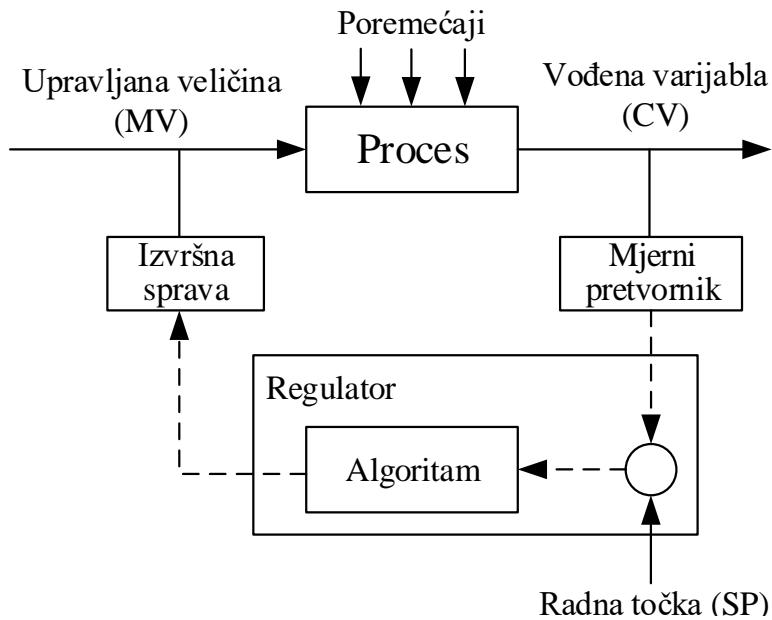
Slika 28: Shematski prikaz regulacijskog kruga
