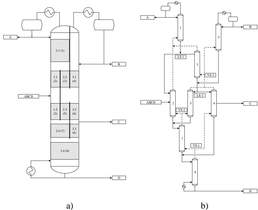
Slika 31: Raspored sekcija u 2-3-3 konfiguraciji KRS (a) i shema simulacijskog modela sa osam kolona (b). Brojevi u zagradama označavaju broj kolone u kojoj se simulira ta sekcija.
