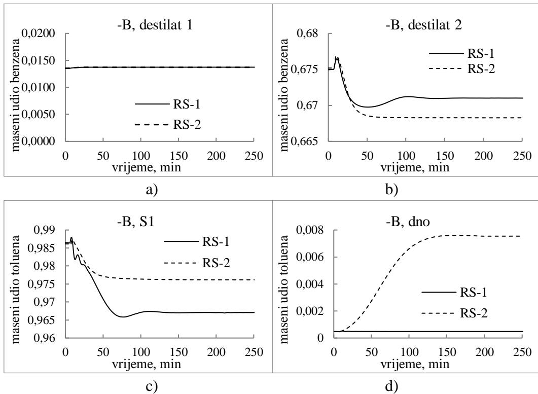
Slika 55: Odzivi sastava ključnih komponenti proizvoda na promjenu sastava benzena (-10%) u ulaznoj struji: a) lijevi destilat, b) desni destilat, c) S1, d) proizvod dna
