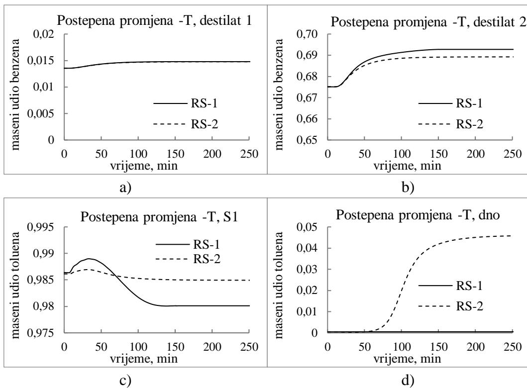
Slika 56: Odzivi sastava ključnih komponenti proizvoda na postupnu promjenu sastava toluena (-10%) u ulaznoj struci: a) lijevi destilat, b) desni destilat, c) S1, d) proizvod dna
