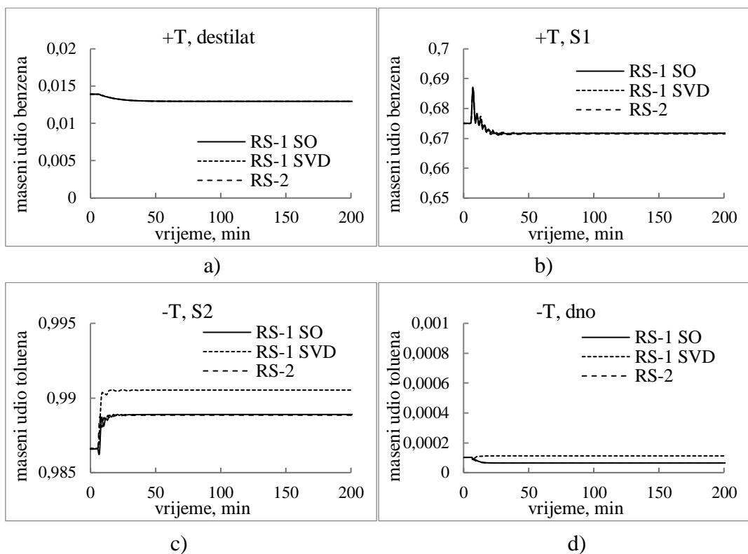
Slika 39: Odziv sastava ključnih komponenti proizvoda na promjenu sastava toluena (+10%) u ulaznoj struji: a) destilat, b) gornji bočni proizvod (*S1*), c) donji bočni proizvod (*S2*), d) proizvod dna. *RS-1 SO* označava regulacijsku shemu dobivenu temeljem analize osjetljivosti, dok *RS-1 SVD* označava regulacijsku shemu dobivenu temeljem SVD analize.
