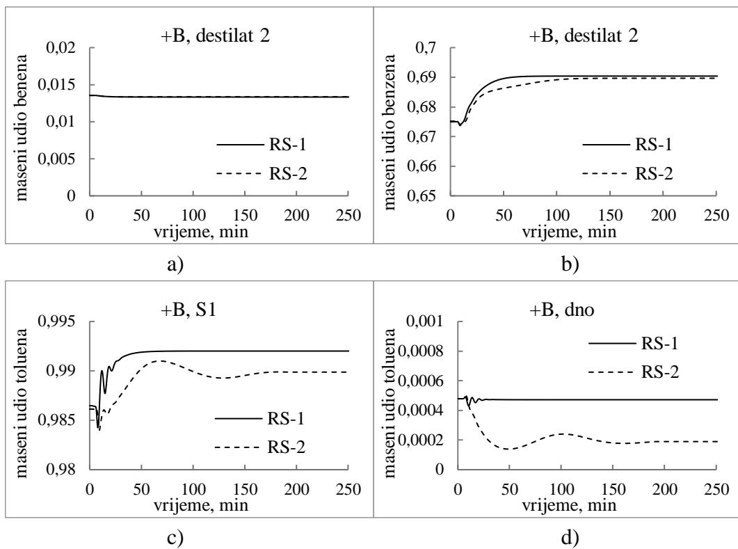
Slika 54: Odziv sastava ključnih komponenti proizvoda na promjenu sastava benzena (+10%) u ulaznoj struji: a) lijevi destilat, b) desni destilat, c) S1, d) proizvod dna
