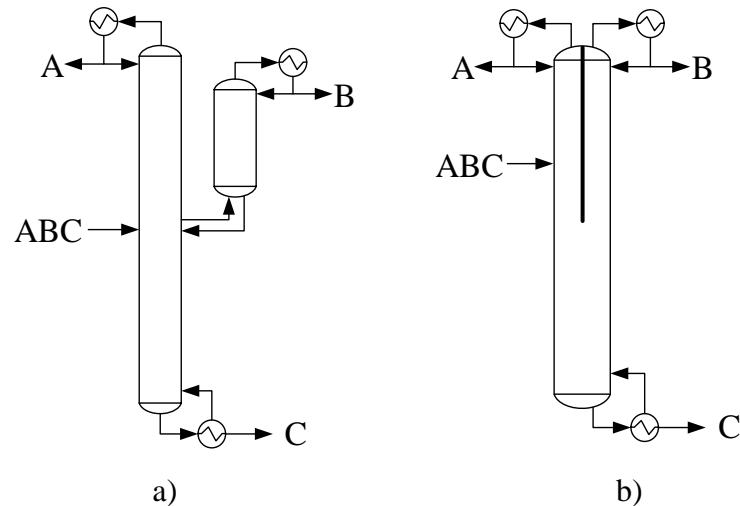
Slika 8: Destilacijska kolona s bočnim rektifikatorom (a) i izvedba odgovarajuće KRS (b)
