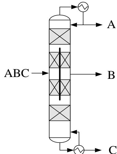
Slika 6: Pojednostavljeni shematski prikaz sekcija unutar prve izvedene KRS za tri proizvoda
