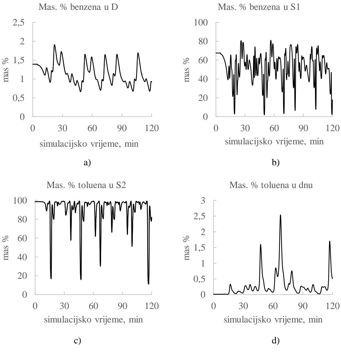
Slika 33: Vremenski odziv kvalitete proizvoda dobiven rezultirajućim sustavom za vođenje:
