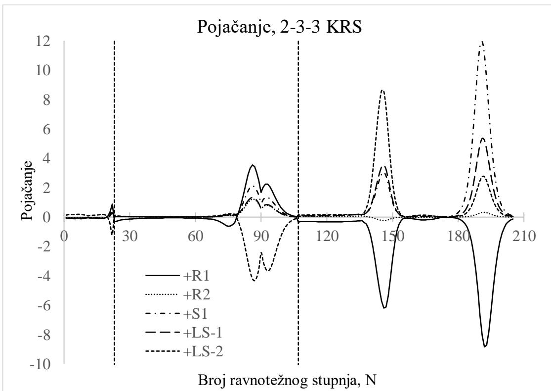
Slika 48: Grafički prikaz statičkog pojačanja ovisno o promjeni vrijednosti pojedinog stupnja slobode 2-3-3 konfiguracije KRS
