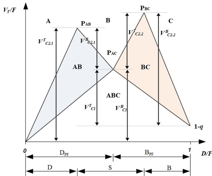
Slika 12: Primjer  $V_{\min}$  dijagrafma za separaciju tri proizvoda
