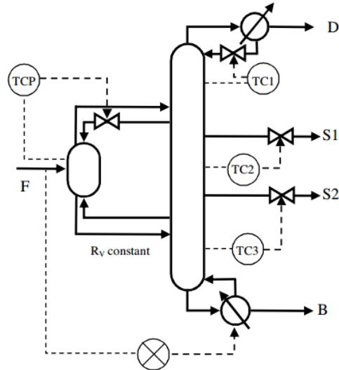
Slika 25: Razvijena temperaturna regulacijska shema za vođenje Kaibelove kolone u radu
