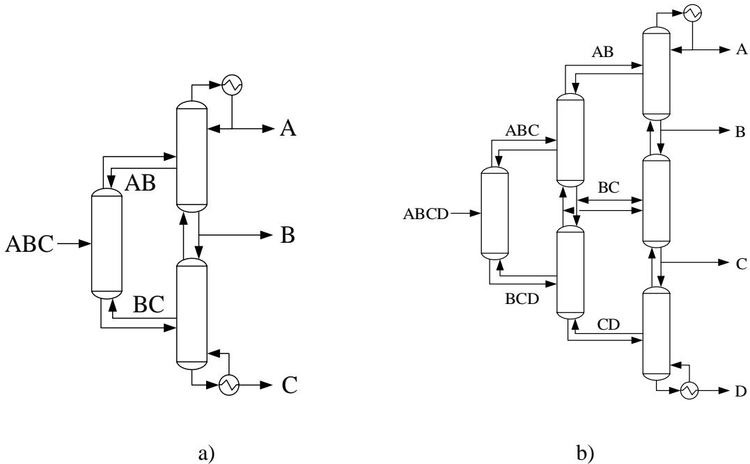
Slika 5: Petlyukov destilacijski niz za tri proizvoda (a) i za četiri proizvoda (b)
