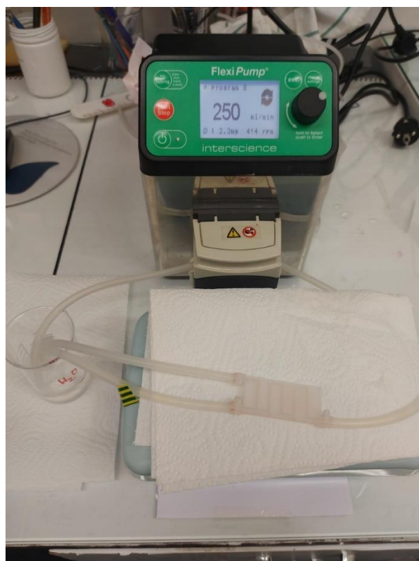
Slika 43. Aparatura za ispitivanje promjene boje kanala mikroreaktora
