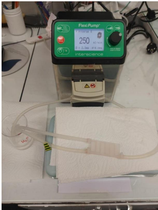
Slika 43. Aparatura za ispitivanje promjene boje kanala mikroreaktora
