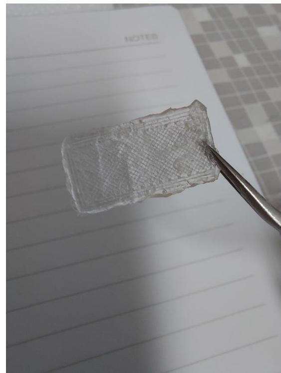
Slika 49. Pločica PVB-a nakon 10 minuta u acetonu
