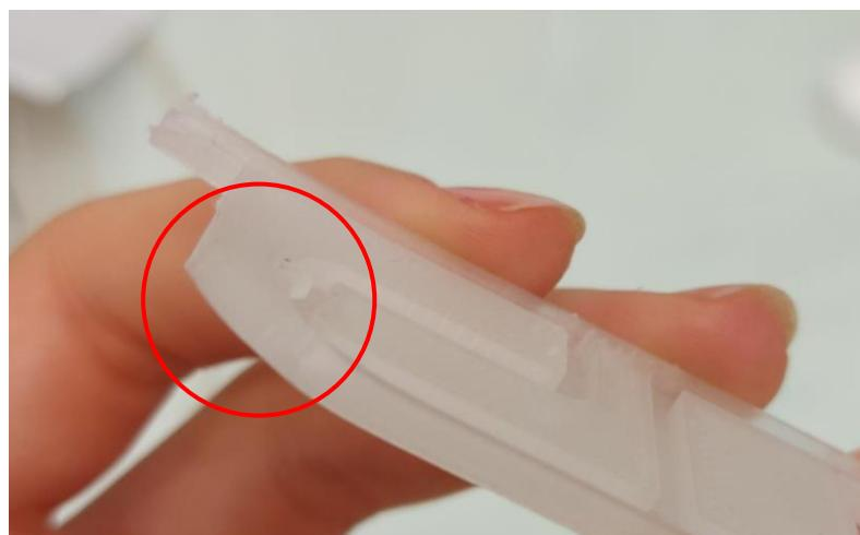
Slika 32. Pogreška u ispisu reaktora
