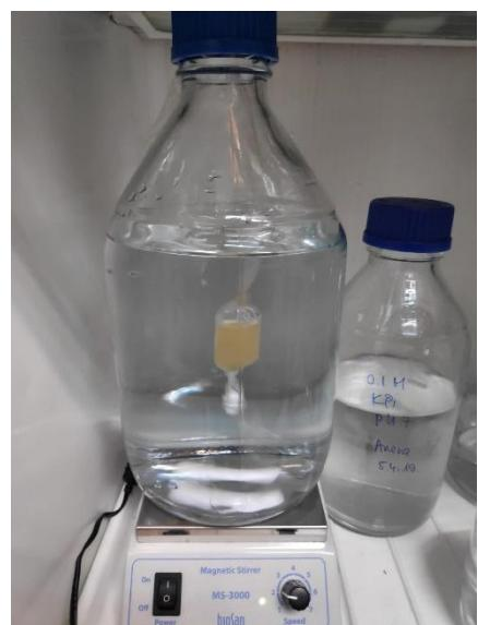
Slika 11. Dijaliza uzorka enzima lipaza TL u natrij-fosfatnom puferu pH 8,00
