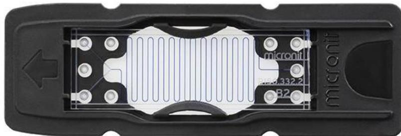
Slika 3. Mikroreaktor širine kanala 500 µm korišten u ovom radu
