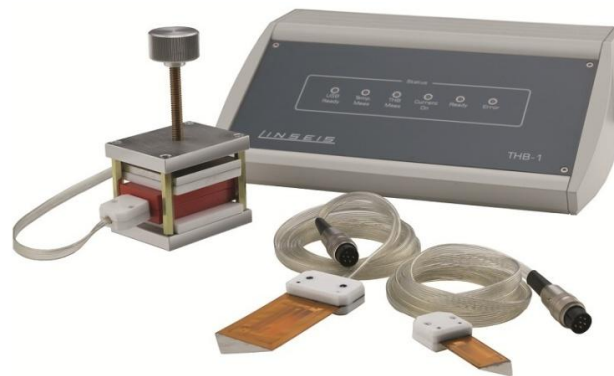
Slika 15. Uređaj za određivanje koeficijenta toplinske vodljivosti
