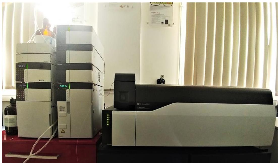
**Slika 3.4.** Shimadzu LCMS-8050
