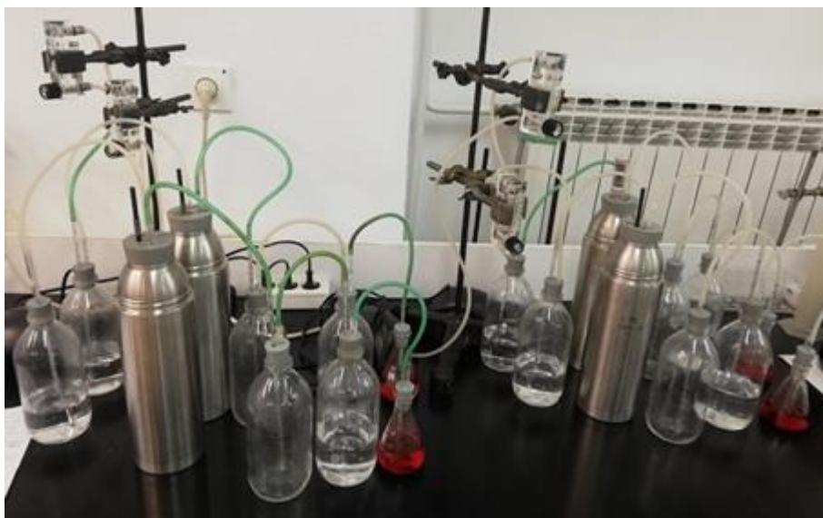
Slika 3.3. Adijabatski reaktor  $V_r = 1 \text{ L}$ .
