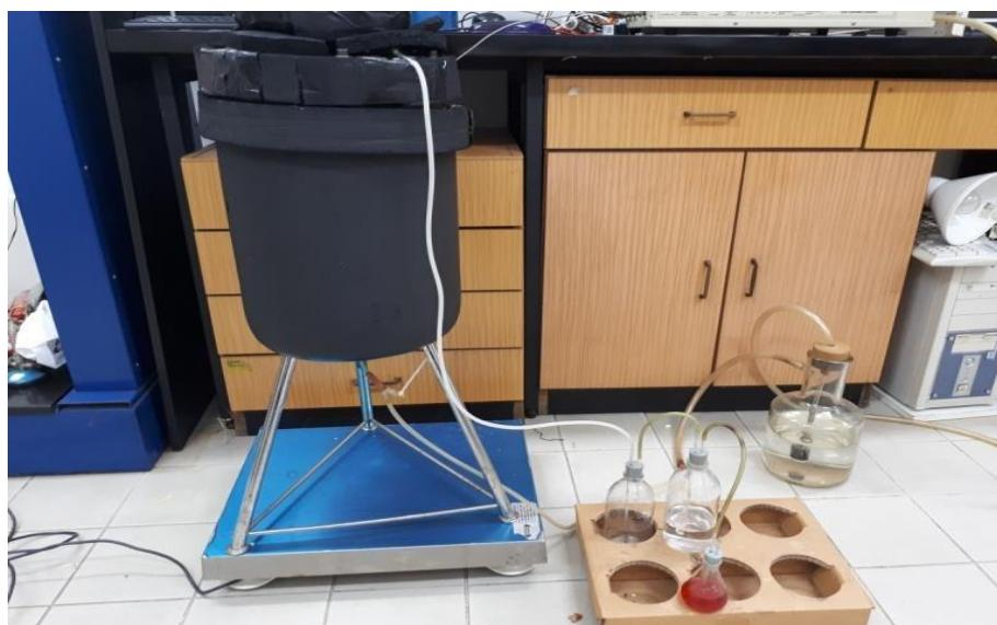
Slika 3.4. Adijabatski reaktor  $V_r = 10 \text{ L}$ .
