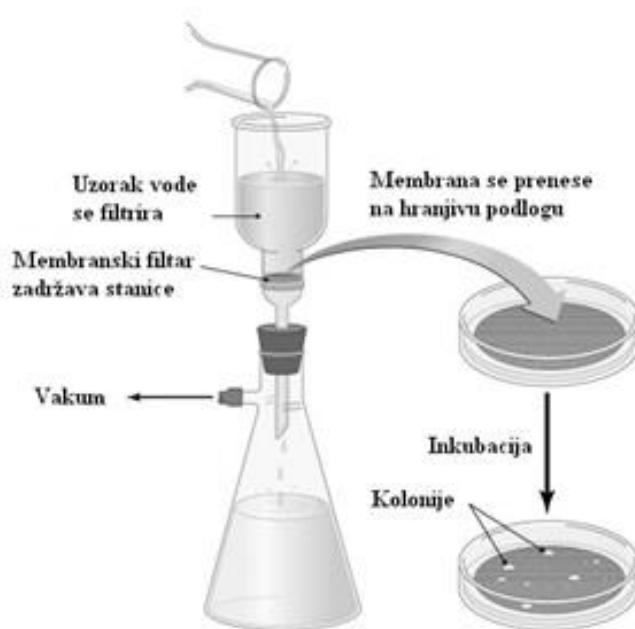
**Slika 3.7.** Metoda membranske filtracije.
