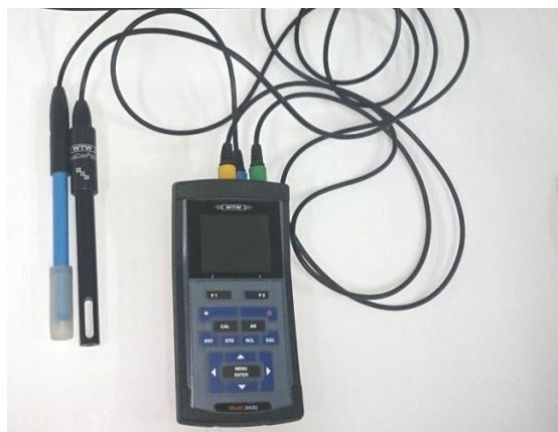
Slika 3.6. Uređaj za mjerenje pH-vrijednosti Multi 340i WTW.
