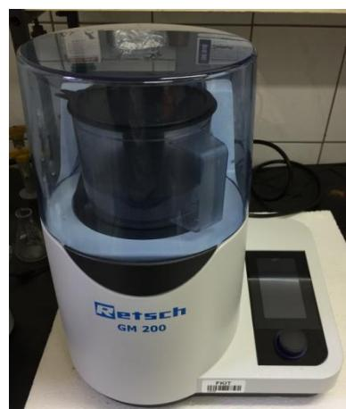
**Slika 3.9.** Mljevilica za usitnjavanje uzorka RETSCH, GM 200.
