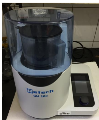
Slika 3.9. Mljevilica za usitnjavanje uzoraka RETSCH, GM 200.
