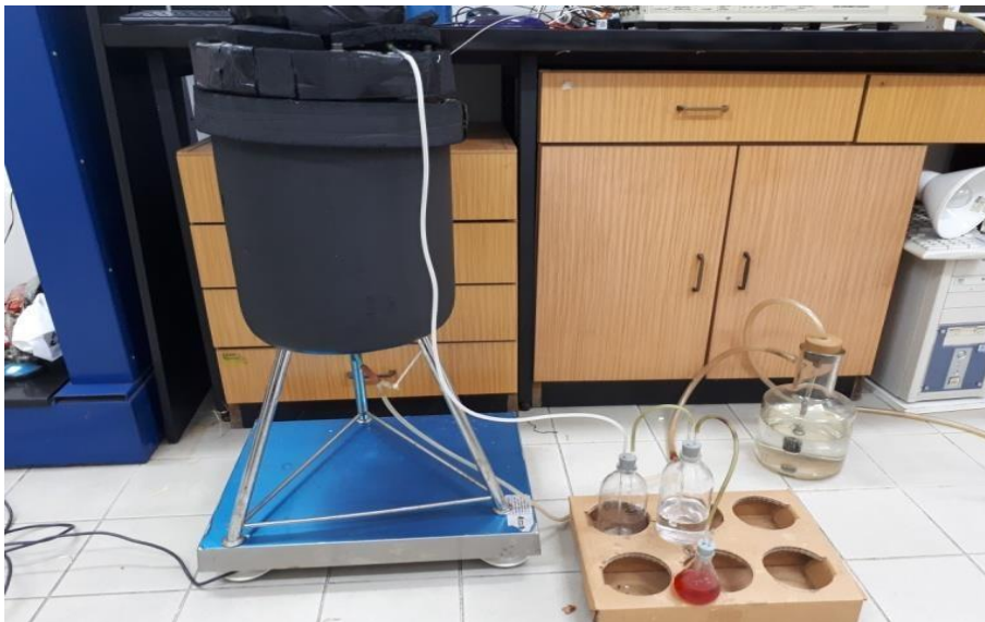
Slika 3.4. Adijabatski reaktor V_r = 10 L.
