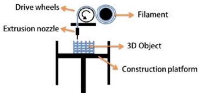
Slika 7. Shematski prikaz metode fuzijskog taloženja. [35]
