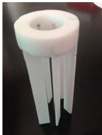
**Slika 6.** Teflonski nosač sa šest pločica
