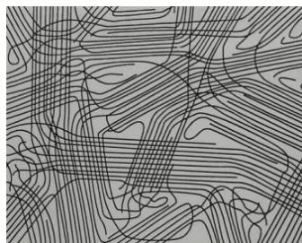
Slika 4. Shematski prikaz rasporeda makromolekula u polietilenu [8]
