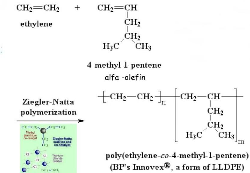
Slika 6. Shematski prikaz dobivanja PE-LLD [9]
