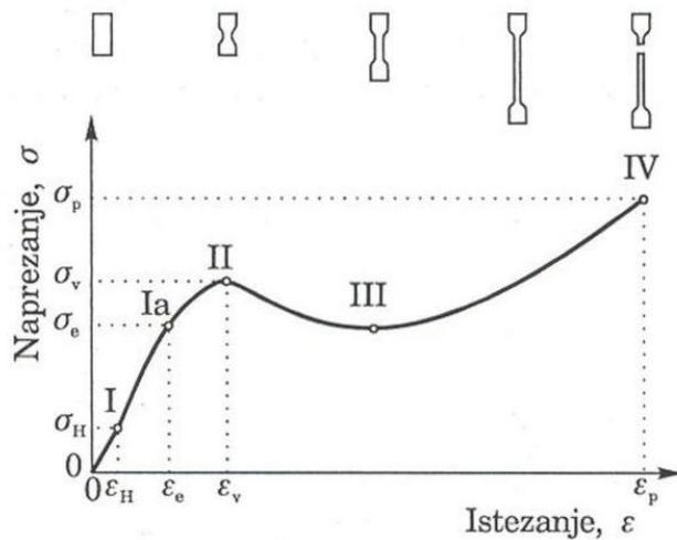
Slika 8. Deformacijska krivulja naprezanje-istezanje – karakteristična područja [8]
