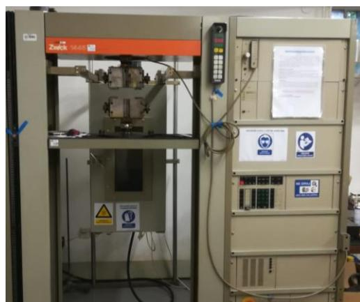
*Slika 15.* Univerzalna mehanička kidalica Zwick 1445.
