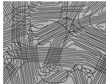
Slika 4. Shematski prikaz rasporeda makromolekula u polietilenu [8]
