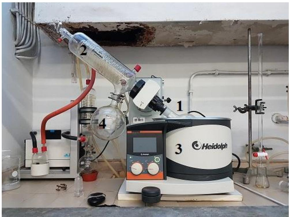
**Slika 3.5.** Aparatura za rotacijsku vakuum evaporaciju: (1) tirkvica s uzorkom, (2) sustav za hlađenje, (3) vodena kupelj, (4) tirkvica za sakupljanje kondenzata
