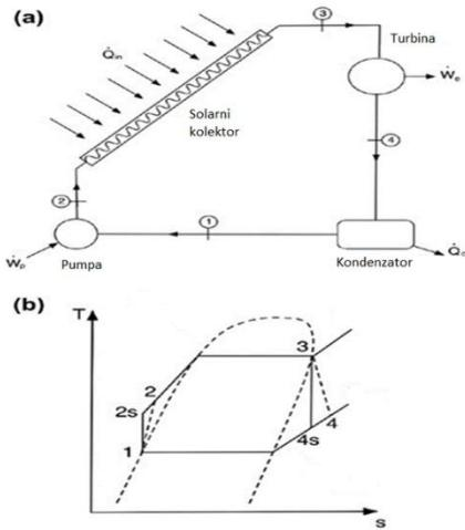
Slika 13. a) Shema solarnog ORC ; b) Prikaz promjena stanja u T-s dijagramu [13]
