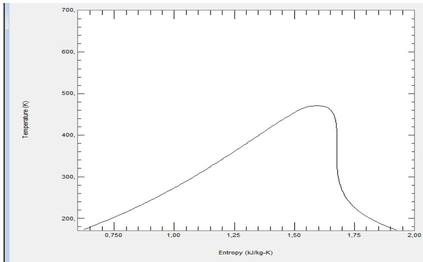
Slika 16. T-s dijagram za izentropski fluid ( R11 – triklorfluormetan)
