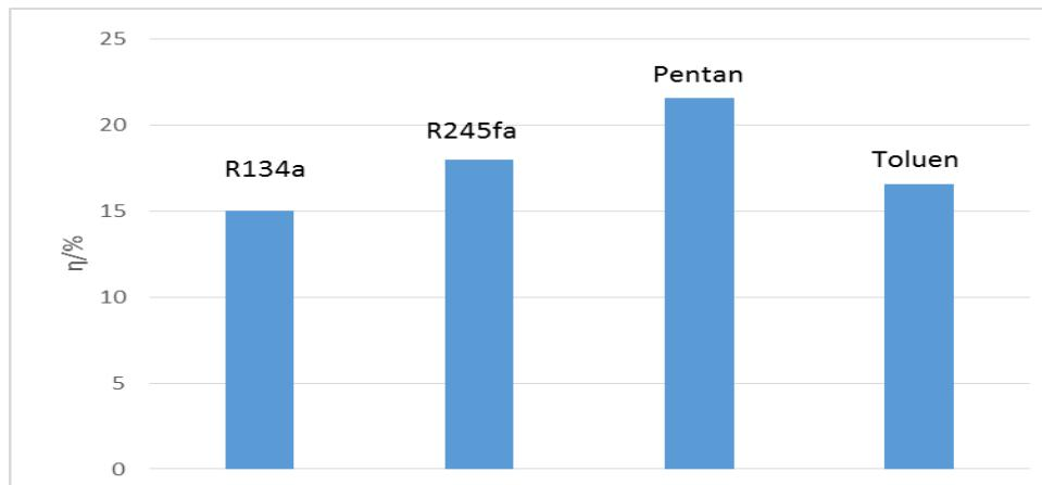
Slika 29. Usporedba stupnja iskorištenja za četiri radne tvari
