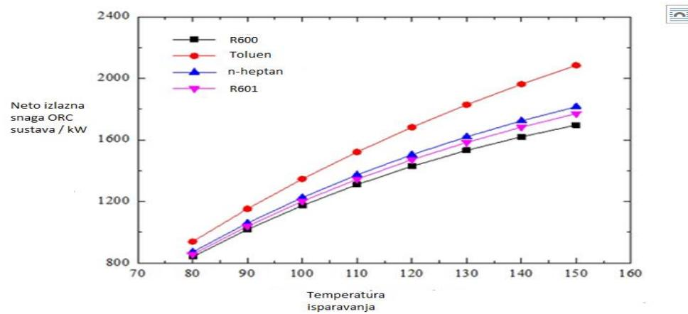
Slika 23. [18] Ovisnost izlazne snage ORC-a koji koristi otpadnu topline plinske turbine o temperaturi isparavanja
