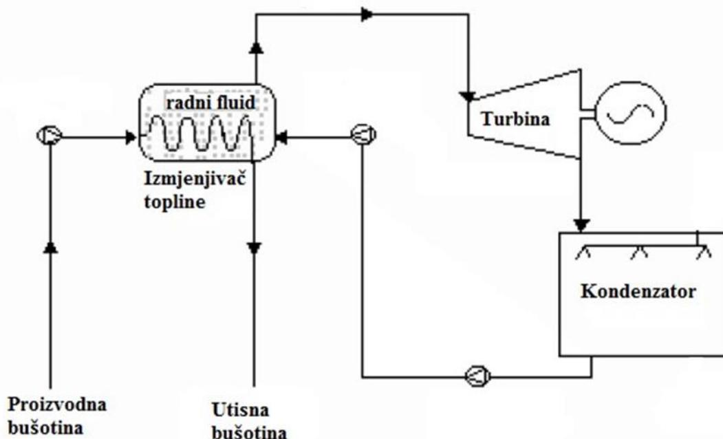
Slika 11. Shema geotermalne elektrane s dvostrukim isparavanjem [ 11]
