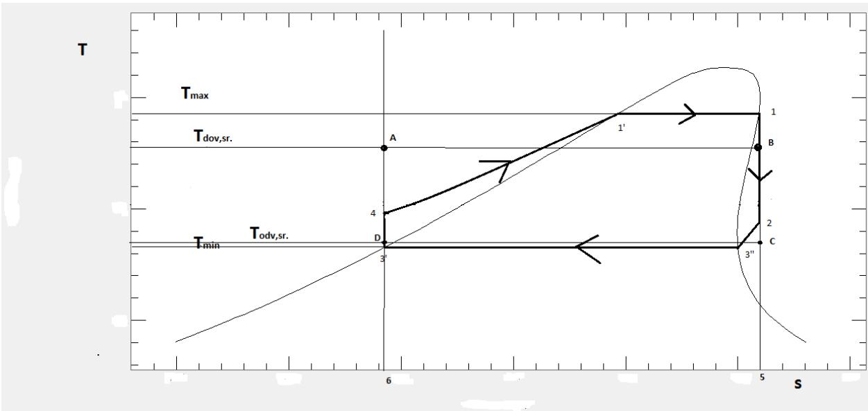
Slika 8. ORC proces sa srednjim temperaturama dovoda/odvoda topline
