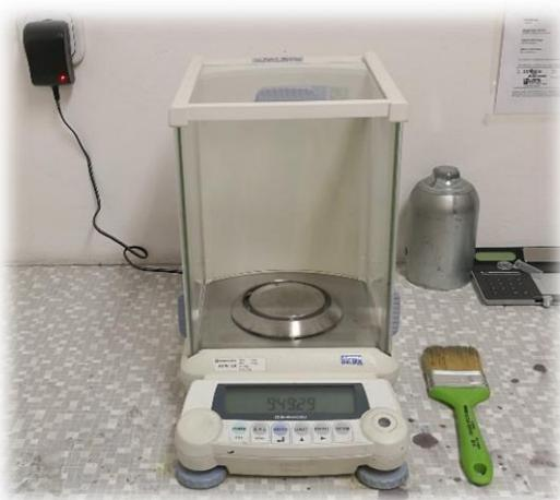
*Slika 3.4 Analitička vaga Shimadzu*
