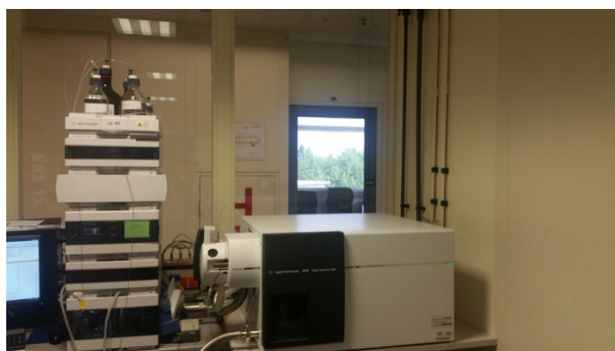
Slika 18 - UHPLC Agilent Series 1290 sa spektrometrom masa
