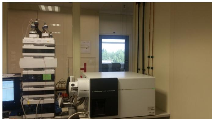
*Slika 18 - UHPLC Agilent Series 1290 sa spektrometrom masa*
