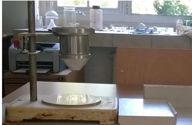
Slika 15. Aparatura za određivanje kuta mirovanja
