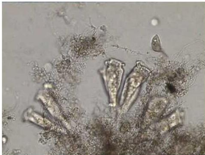
Slika 3. Pahuljica aktivnog mulja pod mikroskopom 10
