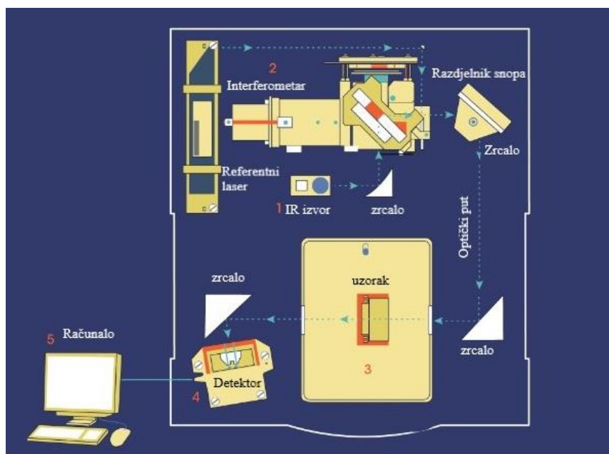
Slika 2-11. Shema FTIR spektrometra
