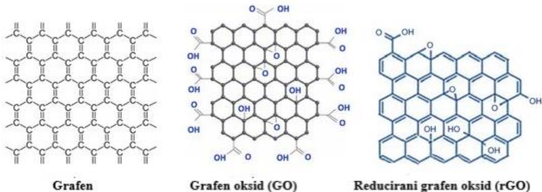
Slika 2-5. Grafen, grafen oksid i reducirani grafen oksid
