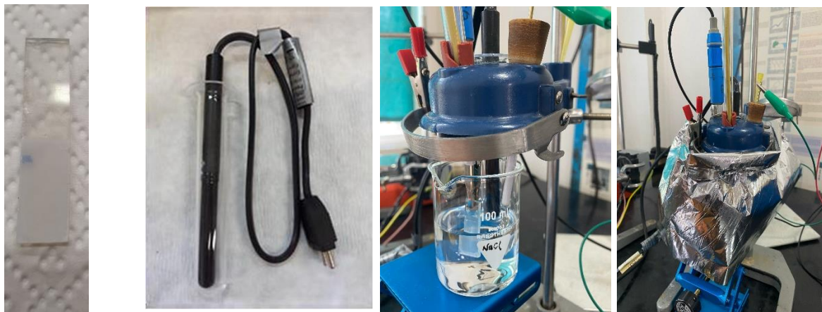
Slika 3.3. TiO 2 elektroda, UV lampa, elektrokemijska ćelija i elektrokemijska ćelija pod utjecajem UV svjetlosti, zaštićena zbog mogućih neželjenih učinaka
