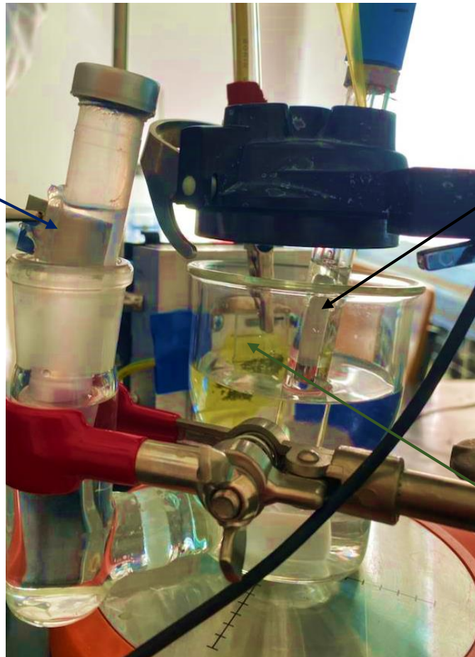
Slika 3.4. Prikaz dijelova troelektrodnog sustava
