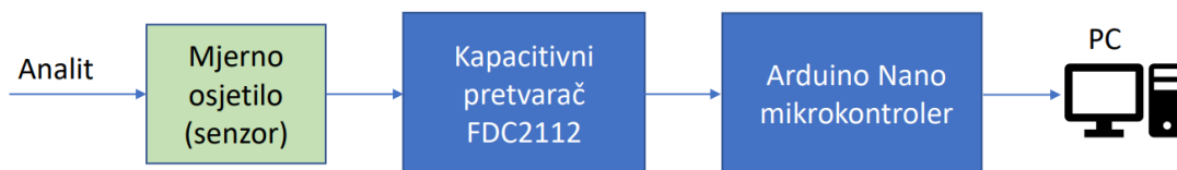
Slika 4.3 Blok shema mjernog sustava.
