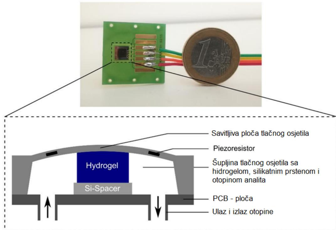
Slika 2.7 Shema piezorezistivnog senzora za etanol na bazi hidrogela.
