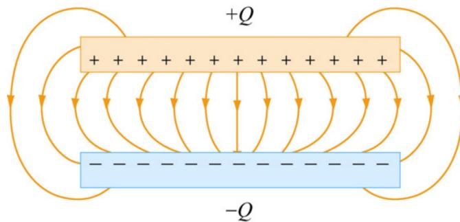
Slika 3.2 Električno polje između paralelnih ploča kondenzatora.
