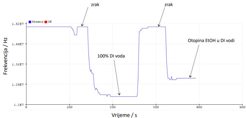
Slika 4.13 Dijagram odziva mjernog sustava u vremenu.
