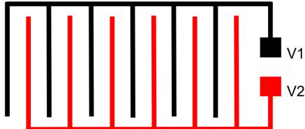
Slika 3.6 Interdigitalni kondenzator.
