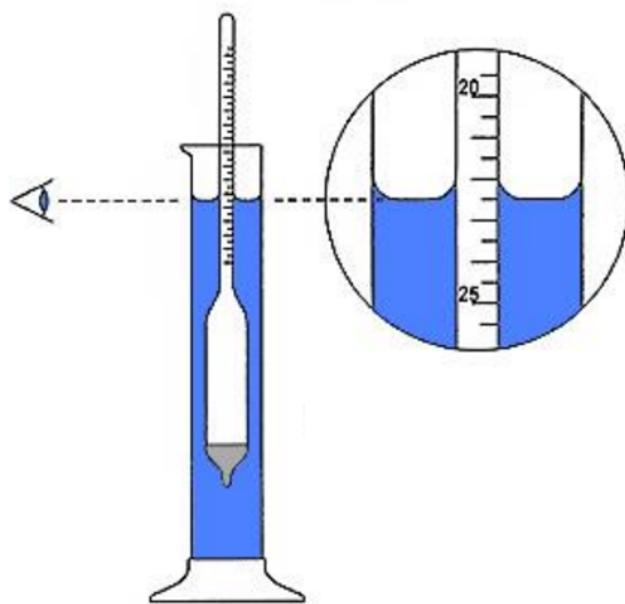
Slika 2.15 Očitavanje hidrometra.
