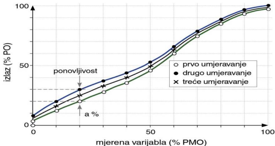
Slika 3.15 Ponovljivost mjernog pretvornika pri provedbi baždarenja .
