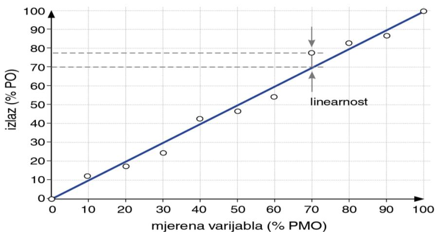
Slika 3.13 Određivanje linearnosti iz staticke karakteristike mjernog pretvornika.
