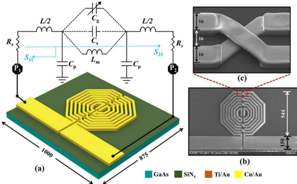
Slika 2.9 Shematski prikaz senzora. (a) Višeslojni spiralno spojena osmerokutna rezonatorska struktura ostvarena IPD obradom veličine  $1\text{ mm} \times 0,875\text{ mm}$  (b) skenirana elektronska mikroskopija (SEM); (c) Uvećani prikaz zračnog mosta. (Napomena: sve dimenziije su u mikrometrima).
