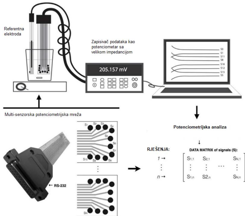
Slika 2.5 Baza podataka o profilima signala generiranih potenciometrijskim uređajem s e-jezikom koji se sastoji od K nizova senzora svaki s N senzora, tijekom analize M uzoraka.
