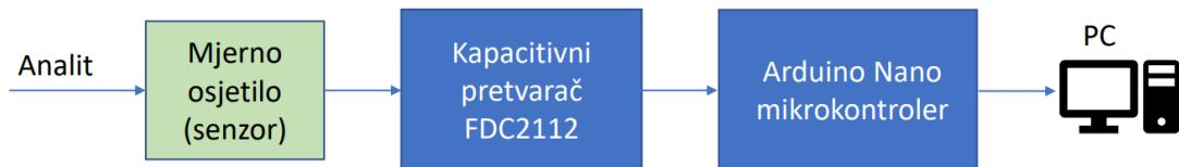
Slika 4.3 Blok shema mjernog sustava.
