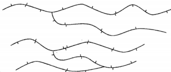
Slika 2. Pojednostavljen prikaz strukture polietilena niske gustoće 14
