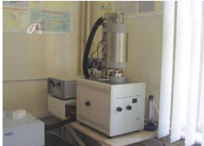
**Slika 14.** Termogravimetrijski analizator (TGA) NetzschSTA409
