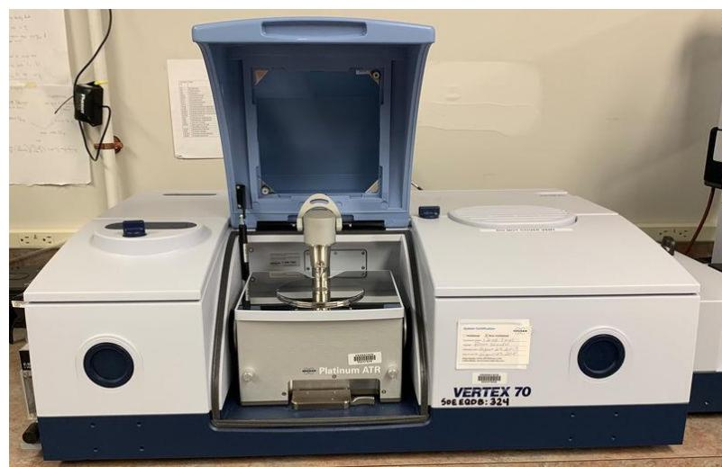
**Slika 13.** Bruker Vertex FTIR 70 spektrometar s Platinum ATR
