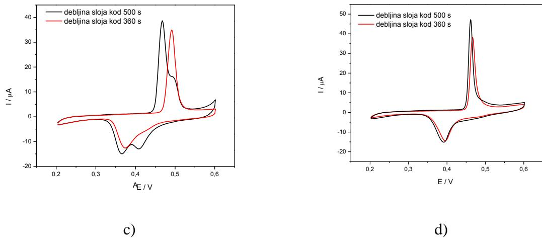
**Slika 23.** Ciklički voltamogrami kod potencijala od  $E^2=1,2$  V pri vremenu depozicije od: a) 360 s, b) 500 s, c) usporedba kod različitih debljina s Nafionom (crna krivulja za sloj od 500 s i crvena za sloj od 360 s), d) usporedba kod različitih debljina bez Nafiona (crna krivulja za sloj od 500 s i crvena za sloj od 360 s).
