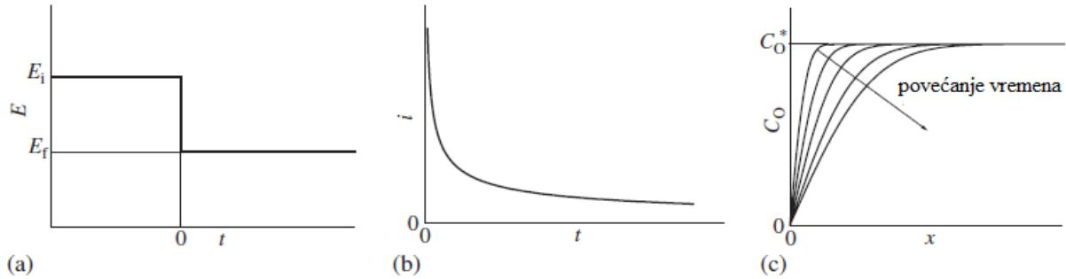
**Slika 6.** Kronoamperometrijsko mjerjenje planarnom elektrodom: (a) pobuda potencijala, (b) odziv struje i (c) koncentracijski profil u blizini elektrode
