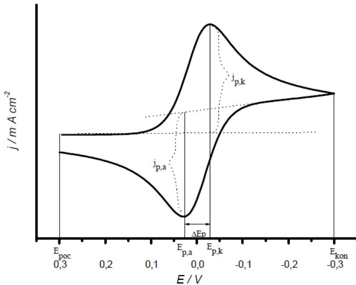
**Slika 11.** Voltamogram za reverzibilni elektrodnji proces
