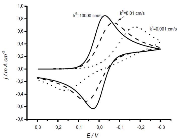
**Slika 10.** Ciklički voltamogram redoks para O/R za različite vrijednosti konstanti brzine reakcije prijelaza naboja ( $k^0$ ) ( $E^0 = 0 \text{ V}$ ,  $c_o = 5 \cdot 10^{-3} \text{ mol dm}^{-3}$ ,  $v = 1 \text{ V/s}$ ,  $D_o = D_R = 10^{-5} \text{ cm}^2/\text{s}$ )
