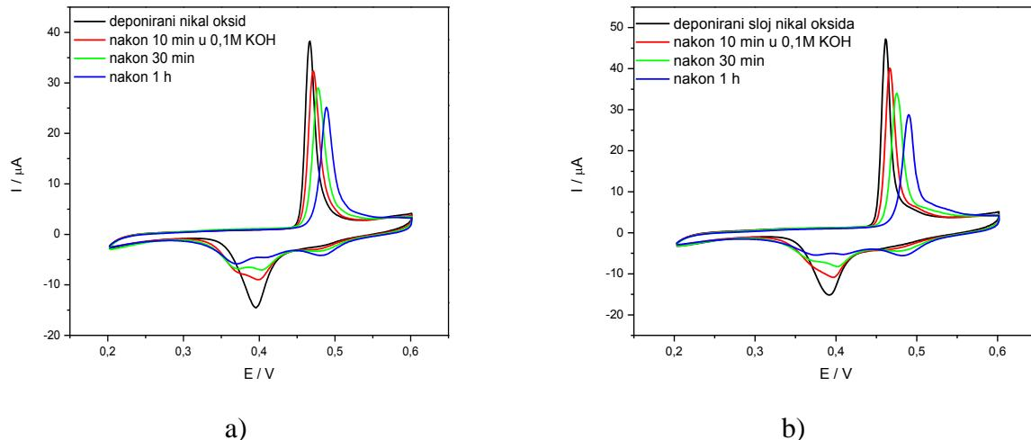
**Slika 18.** Ciklički voltamogrami za elektrode E3 i E4 snimljeni u 0.1 M otopini KOH uz promjenu brzine potencijala od 5 mV/s. Crna krivlja prikazuje svježe priređeni nikaloksidni sloj dok crvena, zelena i plava krivlja prikazuju ponašanje sloja nakon određenog vremena stajanja u KOH.
