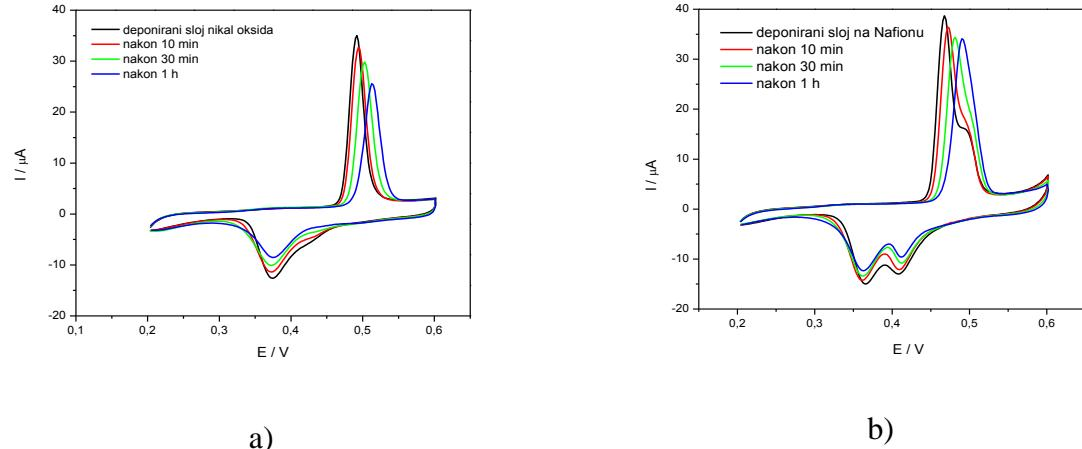
**Slika 20.** Ciklički voltamogrami deponiranog sloja niklovih oksida za elektrode EN3 i EN4 tretirane u  $0,1 \text{ mol/dm}^3 \text{ KOH}$  pri brzini promjene potencijala od  $5 \text{ mV/s}$ .
