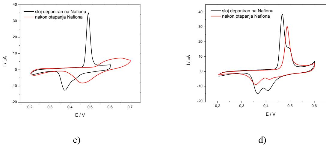
**Slika 21.** Prikaz strujnih odziva deponiranih slojeva nikal oksida na Nafionu za  $E^I = 1,1 \text{ V}$  za debljinu sloja: a) 360 s, b) 500 s. Kod potencijala  $E^2 = 1,2 \text{ V}$  za debljine slojeva: c) 360 s, d) 500 s.
