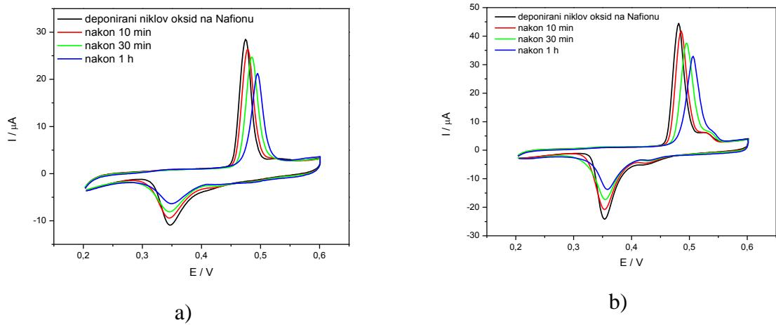
**Slika 19.** Ciklički voltamogrami elektrode EN1 i EN2 snimljeni u  $0,1 \text{ mol/dm}^3 \text{ KOH}$  pri brzini promjene potencijala od  $5 \text{ mV/s}$ .
