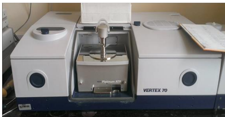
Slika 11. Fotografija FTIR spektrometra Vertex 70 s platinastim detektorom (Bruker, Billerica, SAD)
