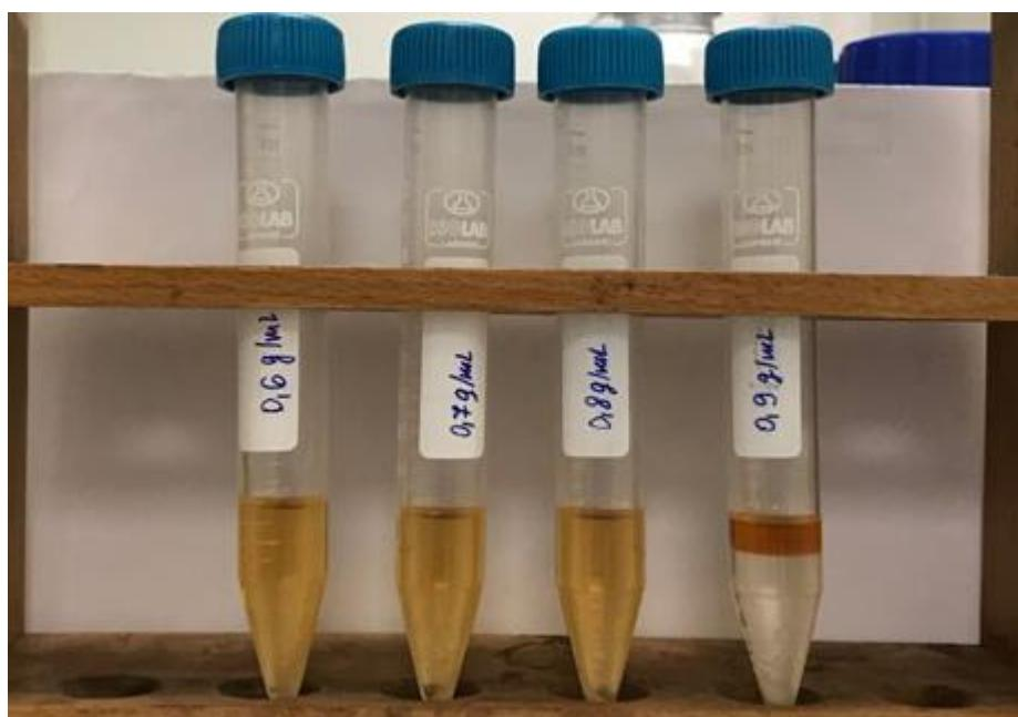
**Slika 5.** Fotografija uzoraka dobivenih šaržnom ekstrakcijom u rasponu koncentracija  $\text{K}_2\text{HPO}_4$   $0,6-0,9 \text{ g/mL}$  uz DES B:U (1:3) 30%
