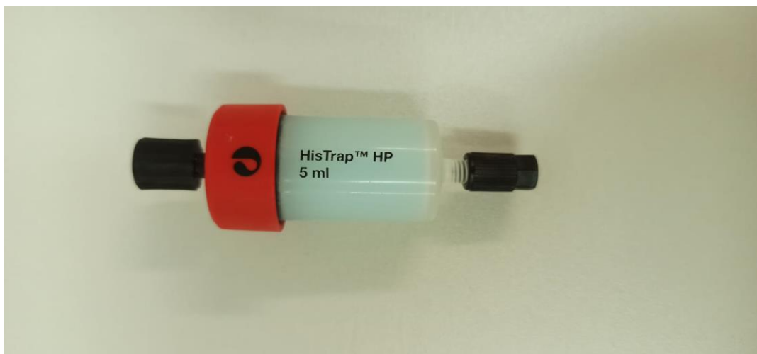
Slika 3.4. Kolona s niklom i nitrilotriocetnom kiselinom
