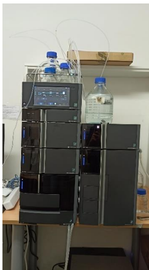
Slika 3.7. Kapljevinska kromatografija visokog učinka
