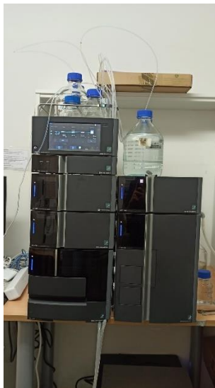
Slika 3.7. Kapljevinska kromatografija visokog učinka
