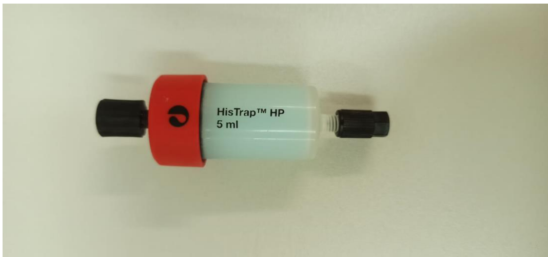
Slika 3.4. Kolona s niklom i nitrilotriocetnom kiselinom
