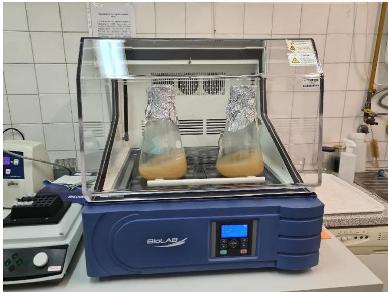
Slika 3.1. Tresilica inkubator
