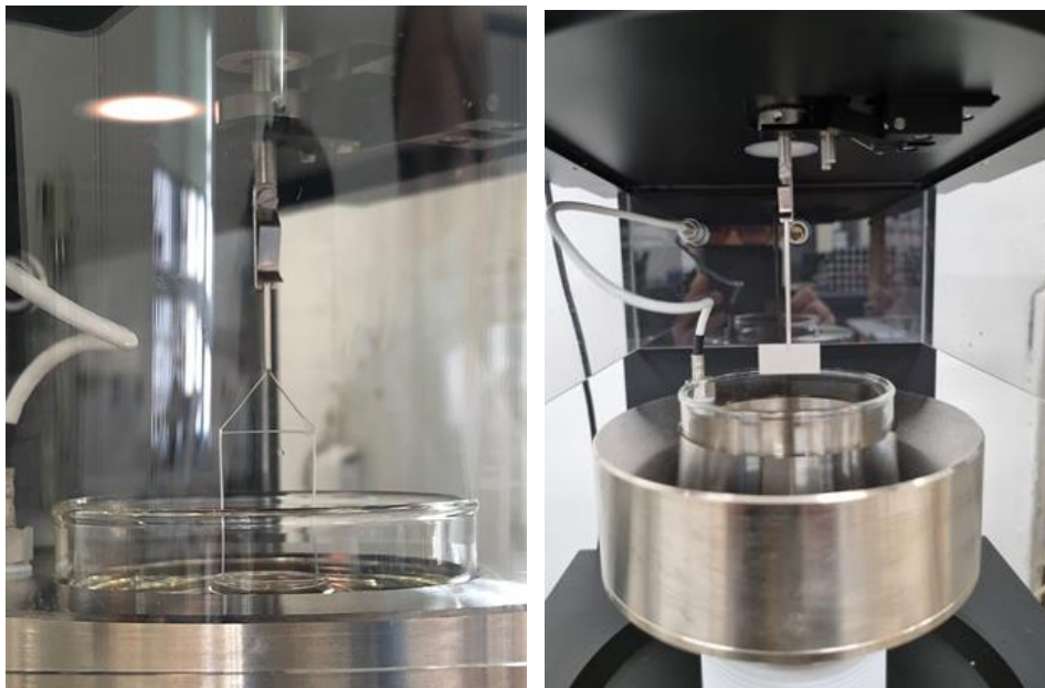
Slika 10. Mjerenje površinske napetosti ulja sa Du Nouy prstenom i Wilhelmi pločicom
